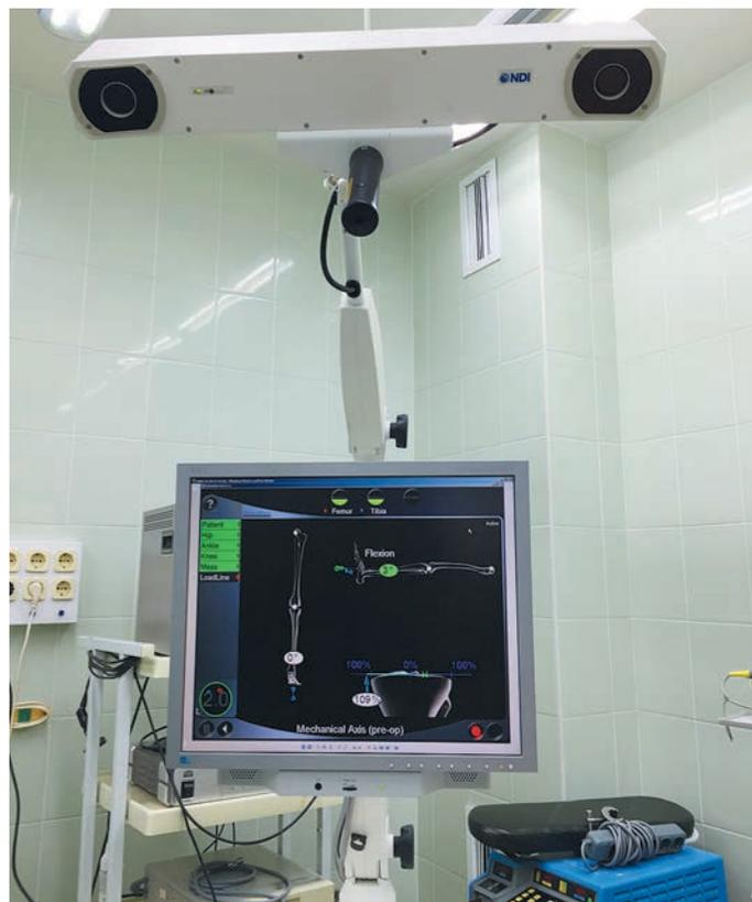
**Компьютерная модель конечности на мониторе комплекса «Ортопилот»**
