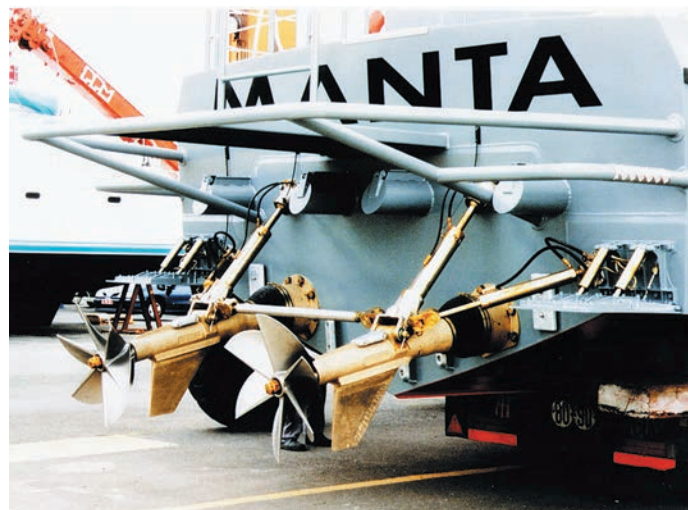
Двухвальный «арнесон». Видны дифференциальные и рулевой гидроцилиндры
