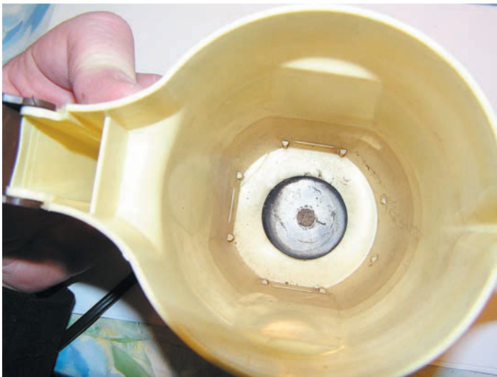
Рис. 2. Нагревательный элемент чайника «Малышок»
