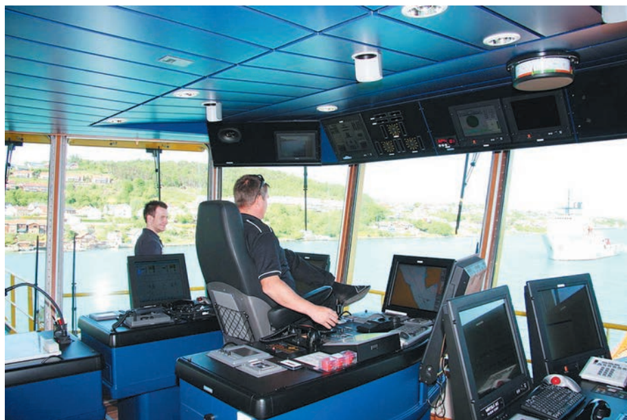
Ходовая рубка гибрида — сплошной компьютер и даже штурвала нет
