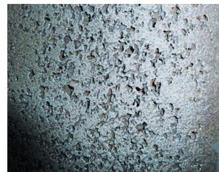
Поверхность металла, изъеденная «холодным кипением»
