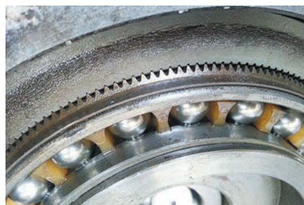
Зацепление гибкого колеса с жёстким «под микроскопом»
