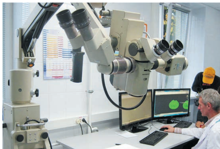
Хирургический микроскоп позволяет наблюдать за работой принтера
