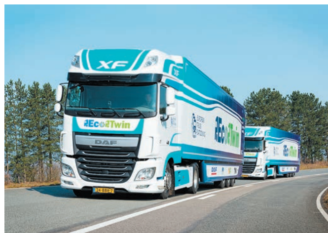
Робокеры-грузовики следуют друг за другом (DAF)
