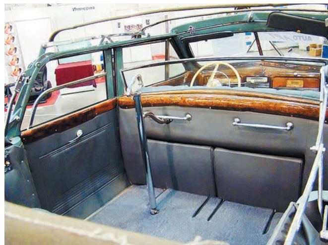
Парадные фэтоны получили кожаный салон и вертикальную стойку с поручнем
