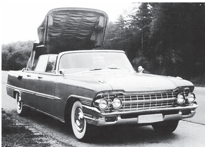
ЗИЛ-111Д оборудовали электрогидравлическим механизмом перемещения мягкого верха
