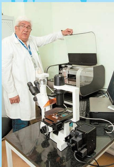
*Комплекс для печати и анализа биodeградируемых матриц для тканевой инженерии. Комплекс состоит из 3D-принтера для пьезоэлектрической печати биологических объектов, управляющего компьютера и микроскопа для анализа морфологии полученных биологических структур*
