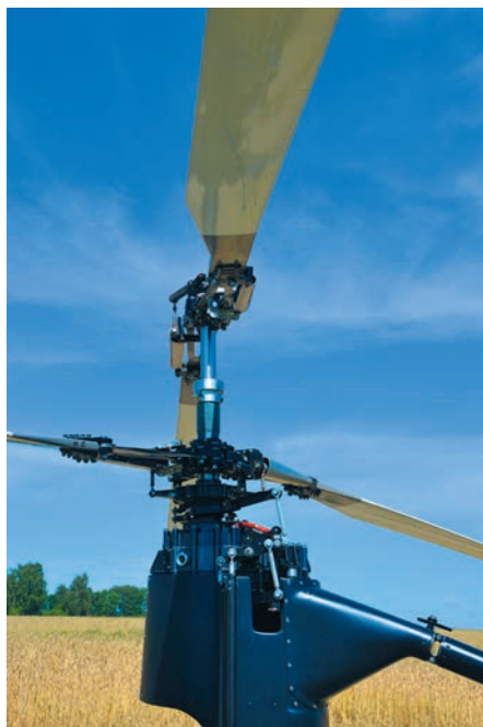
Тяги управления лопастями скрыты внутри вала
