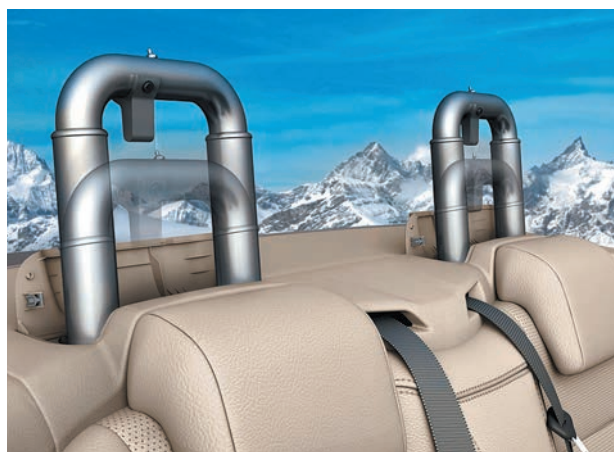
Автоматические дуги безопасности кабриолета
