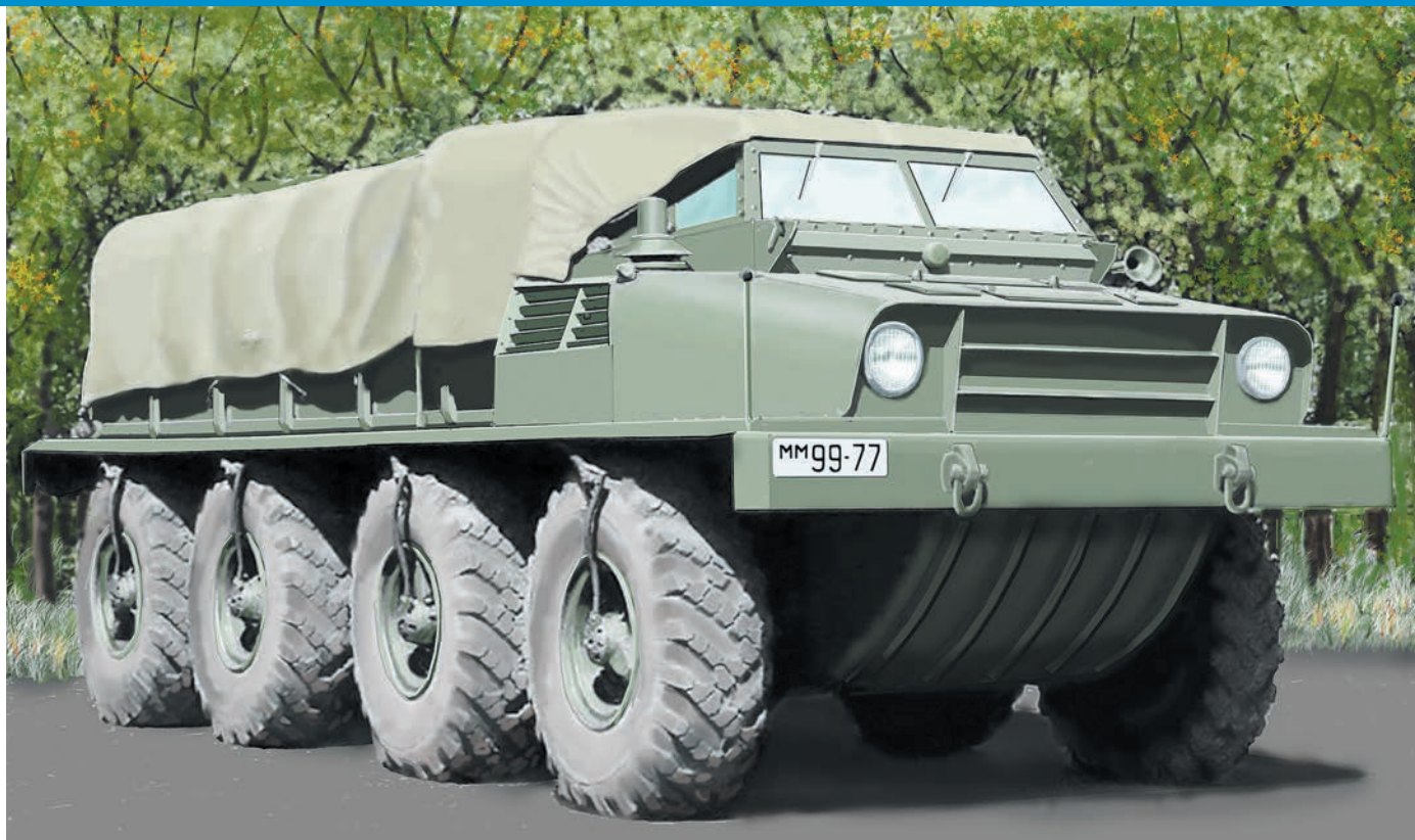
Многоцелевой четырёхосный (8×8) опытный автомобиль сверхвысокой проходимости ЗИС-3134
