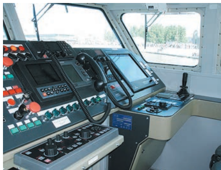
Интерьер рубки «Раптора». Справа — пульт управления боевым модулем «Управа-Корд»
