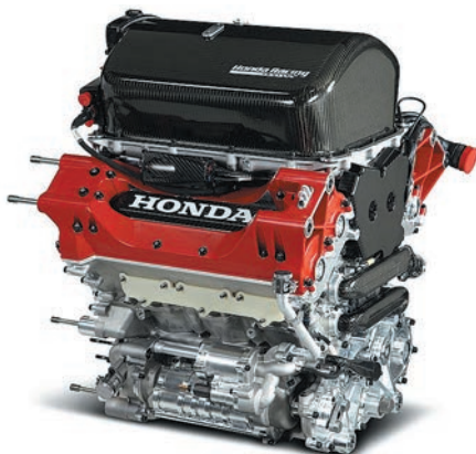
Гоночный мотор индикара, работающий на этаноле
