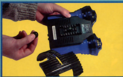
Блок дипольных динамиков удобно крепится к рифленной подставке с помощью шарового крепления. В дальнейшем угол наклона блока можно легко менять, лишь чуть ослабив зажим.
