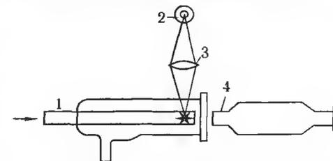
Рис. 10.6. Схема поточного ультрамикроскопа Б. В. Дерягина и Г. Я. Власенко: 1 — кювета; 2 — источник света; 3 — линза; 4 — тубус микроскопа.
