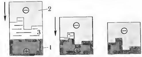
Рис. 38.4. Электрохимическое объемное копирование: 1 — анод; 2 — катод; 3 — электролит.
