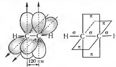
Рис. 29.8. Схема образования  $\pi$ -связей в молекуле ацетилена.
