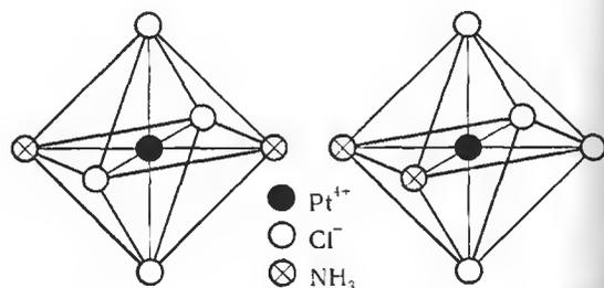
Рис. 13.8. Пространственное строение изомеров  $[\text{Pt}(\text{NH}_3)_2\text{Cl}_4]$ : слева — *транс*-изомер; справа — *цис*-изомер.
