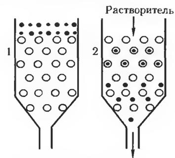
Рис. 10.8. Схема гель-хроматографии: 1 — на колонку с гелем (сферические светлые частицы) нанесен исследуемый раствор; 2 — после промывания колонки растворителем.
