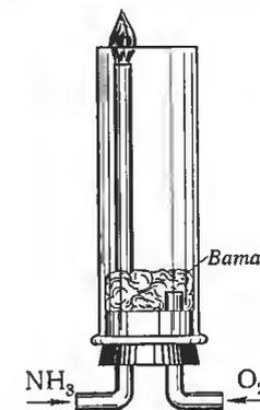
Рис. 17.1. Прибор для демонстрации горения аммиака в кислороде.
