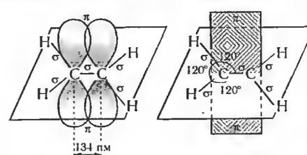
Рис. 29.7. Схема образования  $\pi$ -связи в молекуле этилена.
