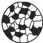
Рис. 12.2. Микроструктура сплавов двух металлов, образующих механическую смесь.
