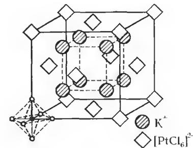
Рис. 13.9. Кристаллическая решетка  $\text{K}_2[\text{PtCl}_6]$ .
