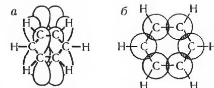
Рис. 29.13. Схема перекрывания  $\pi$ -электронных облаков в молекуле бензола.
