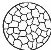
Рис. 12.3. Микроструктура сплавов двух металлов, образующих твердый раствор.
