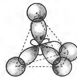
Рис. 29.2. Схема образования  $\sigma$ -связей в молекуле метана.
