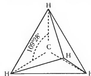
Рис. 29.1. Тетраэдрическая модель молекулы метана.
