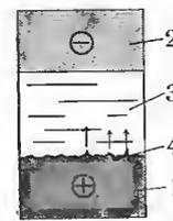
Рис. 38.3. Анодное полирование: 1 — анод; 2 — катод; 3 — электролит; 4 — микронеровности.
