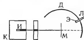
Рис. 2.1. Схема опыта Резерфорда: К — свинцовая капсула с просверленным отверстием; И — источник  $\alpha$ -частиц; М — тонкая металлическая пластинка — фольга; Э — экран; Л — лупа; Д — дуга.
