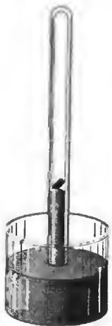
Рис. 16.4. Прибор для демонстрации поглощения аммиака углем.
