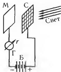
**Рис. 2.3.** Схема установки для наблюдения фотоэлектрического эффекта: М — пластинка испытуемого металла; С — металлическая сетка; Б — источник постоянного электрического напряжения; Г — гальванометр.
