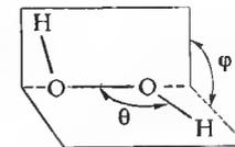
Рис. 19.2. Схема строения молекулы H<sub>2</sub>O<sub>2</sub>. Угол  $\theta$  близок к 95°, угол  $\varphi$  — к 120°. Длины связей: O—H 95 пм, O—O 148 пм.
