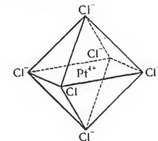
Рис. 13.7. Пространственное строение комплексного иона  $[\text{PtCl}_6]^{2-}$ .
