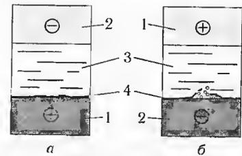
Рис. 38.2. Анодное (а) и катодное (б) травление металлов: 1 — анод; 2 — катод; 3 — электролит; 4 — оксидная пленка.
