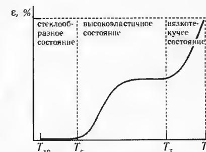
Рис. 31.2. Изменение относительных размеров образца полимера ( $\epsilon$ ) при действии постоянной нагрузки в зависимости от температуры:  $T_{xp}$  — температура хрупкости,  $T_c$  — температура стеклования (размягчения),  $T_t$  — температура текучести,  $T_p$  — температура разложения.
