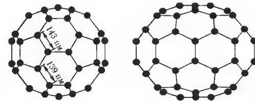
Рис. 16.3. Структуры молекул фуллеренов  $\text{C}_{60}$  и  $\text{C}_{70}$ .
