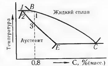
Рис. 32.3 Часть диаграммы состояния системы железо—углерод.
