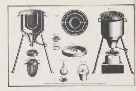
Fig. 16.2. LAVOISIER-LAPLACE ICE CALORIMETER. (From Œuvres de Lavoisier, J. B. Dumas, Ed. [1862], vol. 1, Plate 6.)
