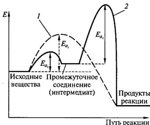
Рис. 2.8. Энергетическая диаграмма процесса без ингибитора (1) и с ингибитором (2)
