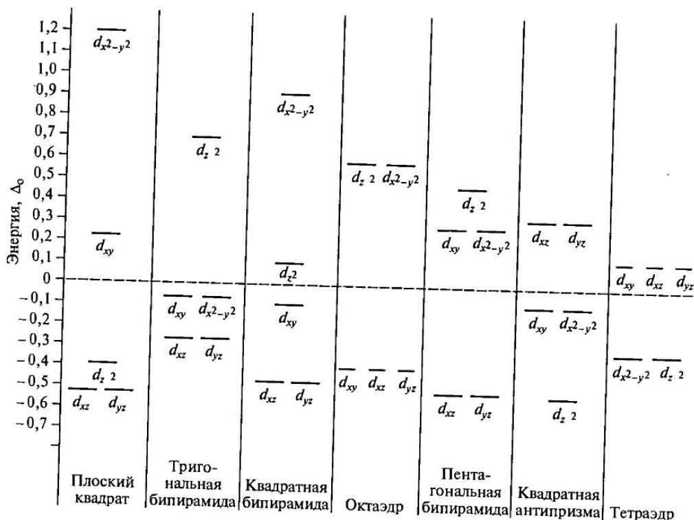
Рис. 4.46. Энергия d -орбиталей при различном окружении относительно сферического поля (в единицах \Delta_0 )
