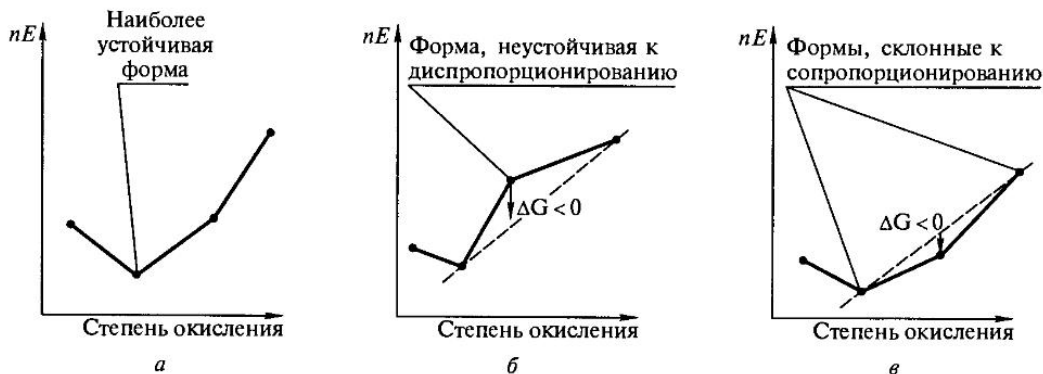
Рис. 1.35. Схемы диаграмм Фроста, иллюстрирующие наиболее стабильные окислительные формы (а), формы, склонные к реакции диспропорционирования (б), и формы, склонные к реакциям сопропорционирования (в)
