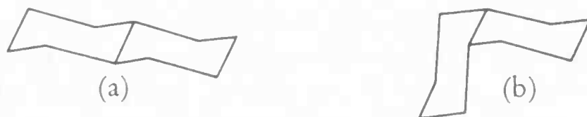
Figure 7.24 (a) trans -Decalin; (b) cis -Decalin.
