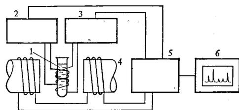
Рис. 36. Принципиальная схема методов ЭПР и ЯМР:
