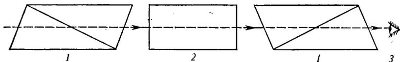
Рис. 43. Схематическое изображение поляриметра:
