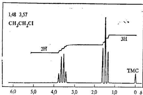
Рис. 39. Спектр ПМР этилхлорида в растворе  $\text{CDCl}_3$
