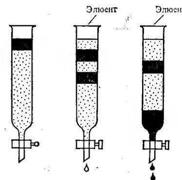
Рис. 1. Принципиальная схема колоночной хроматографии
