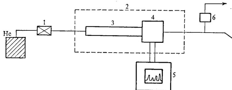
Рис. 4. Принципиальная схема газового хроматографа:
