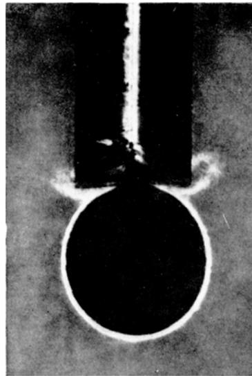
Abb. 5. Die Diffusionsschicht an der Tropfkathode. Nach ANTWEILER.
