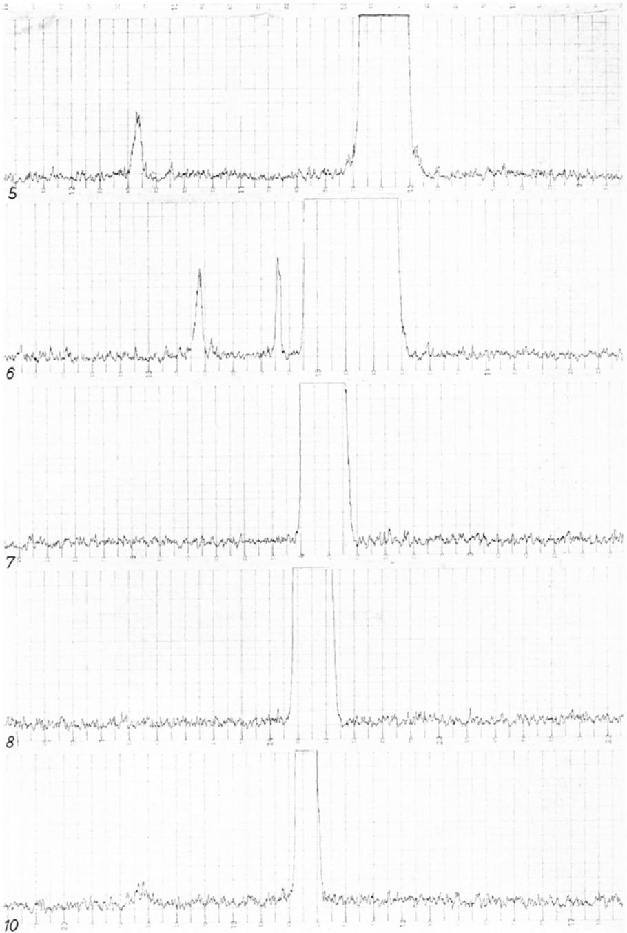
Abb. 2. Intensitätsverteilung der Elektropherogramme bei  $p_H$  5, 6, 7, 8, 10.
