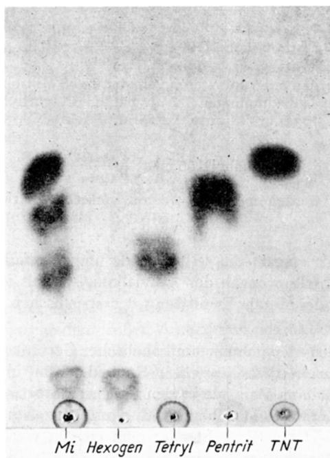
Abb. 6. Dünnschichtchromatographische Untersuchung von Sprengstoffen. Bedingungen: Kieselgel G, Benzol als Laufmittel, angefärbt mit 5 %iger Diphenylaminlösung in Äthylalkohol und 15 min UV-Belichtung bei 254 nm. Dozent Dr. G. Machata, „Analytische Verfahren der naturwissenschaftl. Kriminalistik“
