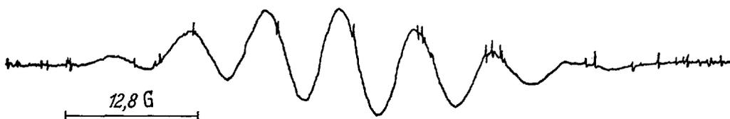
Abb. 8. ESR-Spektrum des N(5)-Methyl-6,7-diphenyl-6,7,8-trihydropterin-Radikalkations, aufgenommen in HCOOH + H<sub>2</sub>O<sub>2</sub>.
