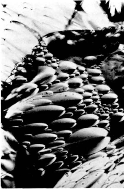
Abb. 8. Fokalkegelschnitt-Textur der smektischen A-Modifikation von 4,4'-Azoxybenzoesäure-di-äthylester. Gekreuzte Polarisatoren,  $\times 120$
