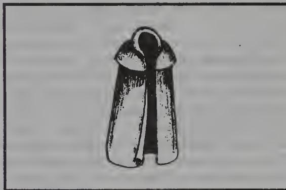
**КЛОТИК**, наделка на верхушке мачты или флагштока в форме сильно сплюснутого шара. Внутри К. заделаны шкивы для подъема флагов и огней.
