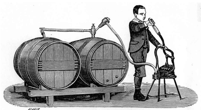
Fig. 33. — Soufflet et siphon à air comprimé, pour transvaser les vins, système Vivez.
