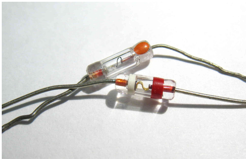
Рисунок 6.9 Корпуса этих полупроводниковых диодов изготовлены из стекла.
