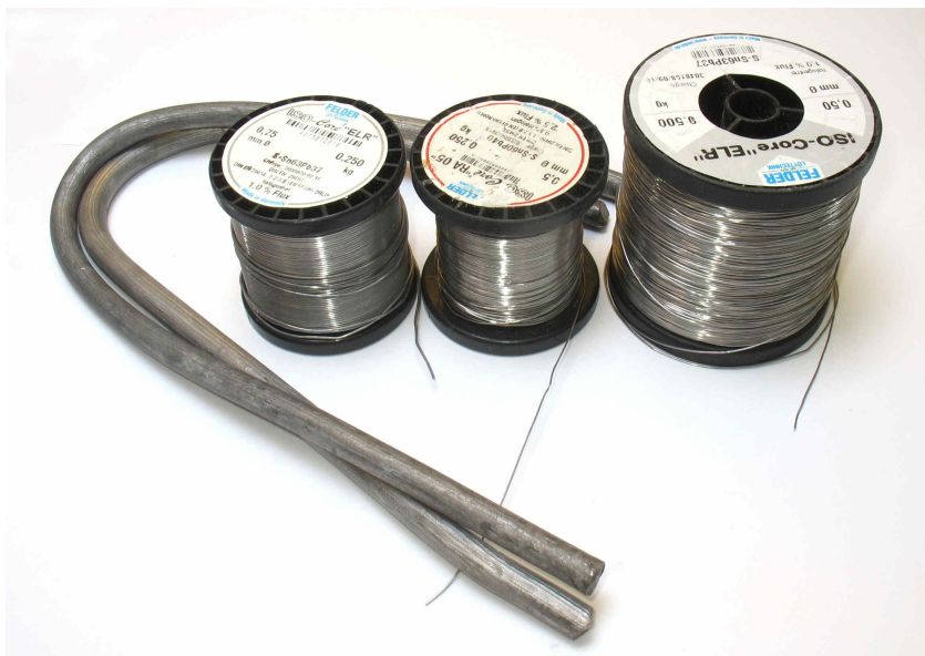
Рисунок 4.1 Катушки и прутки оловянно-свинцовых припоев. Проволока из припоя содержит центральный канал с флюсом, облегчающим процесс пайки.
