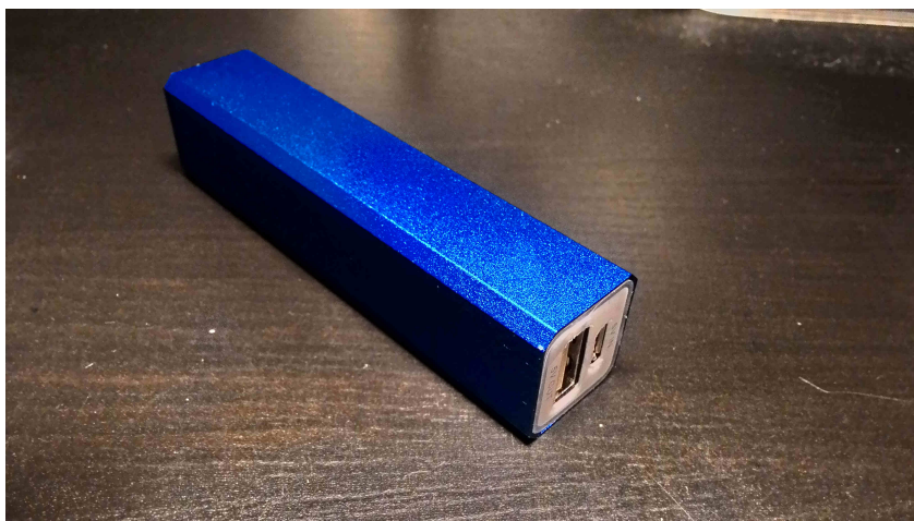
Рисунок 2.11 Алюминиевый корпус внешнего аккумулятора для телефона. Экструдированный анодированный окрашенный профиль.
