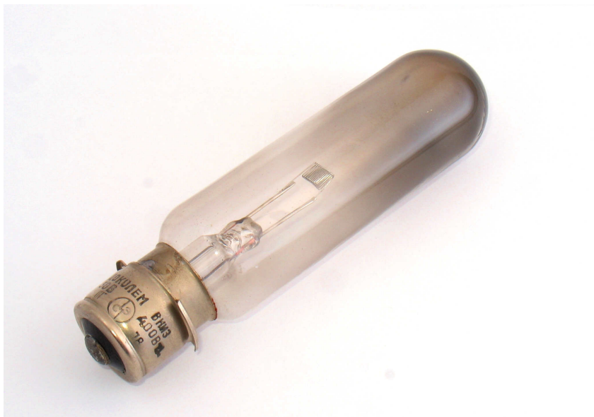
Рисунок 2.18 Мощная лампа накаливания от проектора. Даже тугоплавкий вольфрам со временем испаряется и оседает на стенках колбы в виде темного налета. Данного недостатка лишены галогеновые лампы.
