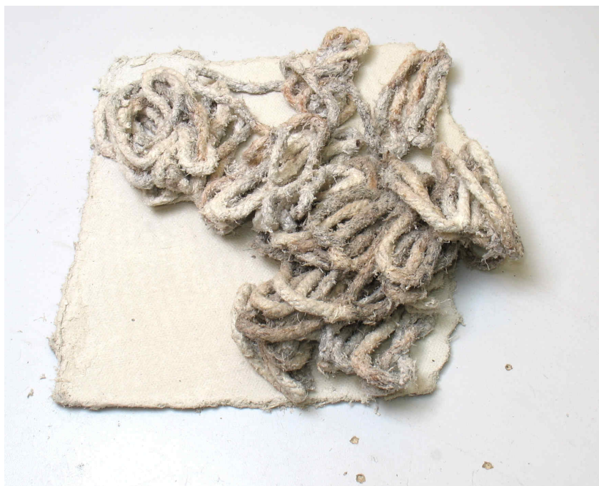
Рисунок 6.21 Кусок асбестокартона и старый грязный асбестовый шнур. Асбест на ощупь очень мягкий и не колет, как стеклоткани.
