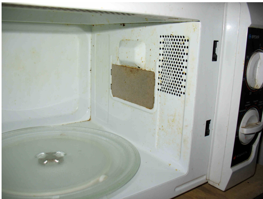
Рисунок 6.11 Слюдяное окошко в микроволновке. Иногда встречаются пластиковые, но только у моделей без гриля.
