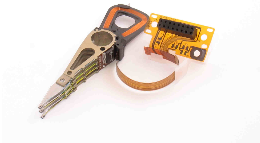
Рисунок 8.25 Разъём, гибкий шлейф, микросхема усилителя — смонтированы на подложке из полиимида.
