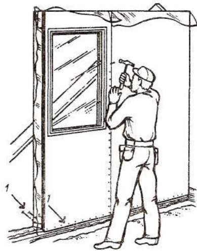
Рис. 31. Монтаж наружной стены из мелко-размерных панелей
