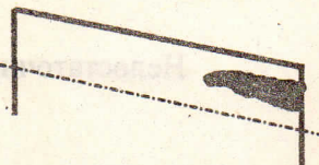
Межосевой угол больше расчетного
