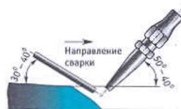
угол наклона мундштука и проволоки
