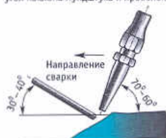
угол наклона мундштука и проволоки
