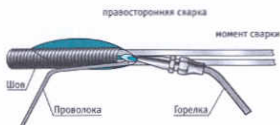
схема движений мундштука и проволоки
