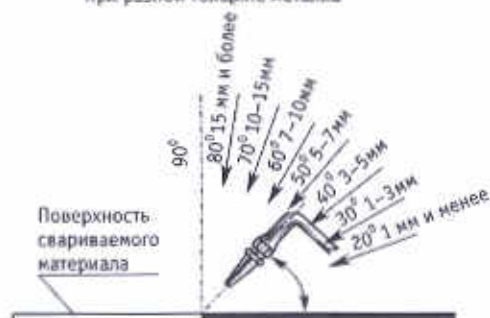
угол наклона мундштука при разной толщине металла
