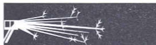
Инструментальная углеродистая сталь (1,2% С)
