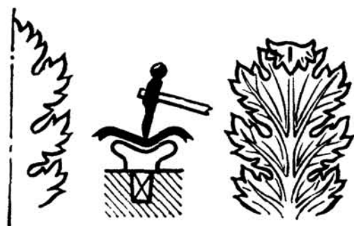
Рис. 149. Изготовление акантовых листьев
