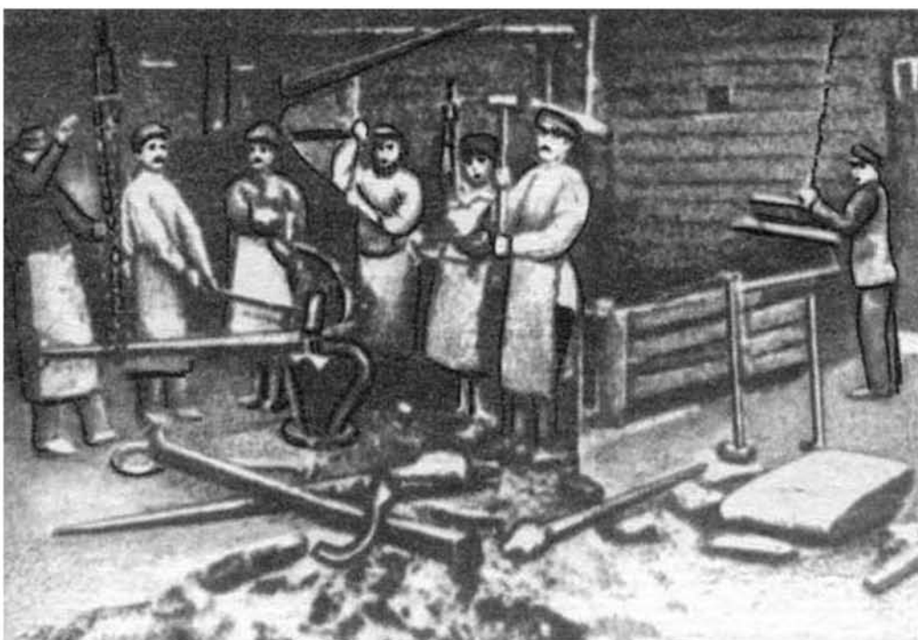
Рис. 14. Ковка якорей вручную
