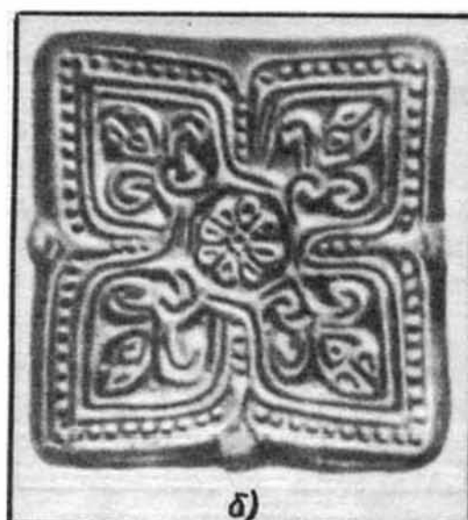
Рис. 142. Листовая штамповка эластичным элементом а-технология, б-штамп
