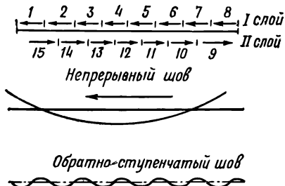
Рис. 48. Обратноступенчатый порядок наложения швов (длинной стрелкой показано общее направление сварки, короткими стрелками — направление сварки участков шва)
