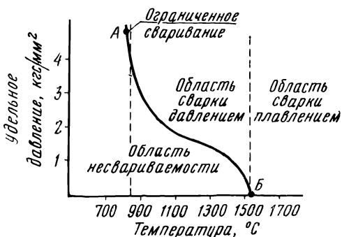
Рис. 1. Зависимость между давлением и температурой сваривания чистого технического железа
