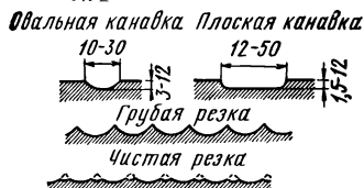
Рис. 99. Схема поверхностной кислородной резки и формы выплавляемых канавок
