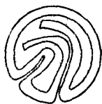
Фиг. 36. Поперечное сечение электродной проволоки с порошковым флюсом во внутренней полости для сварки в \text{CO}_2 .
