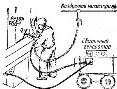
Фиг. 4. Схема соединения аппаратуры для воздушно-дуговой резки.
