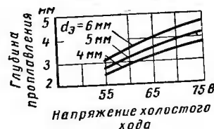
Фиг. 39. Зависимость глубины проплавления от напряжения холостого хода и диаметра электрода. Флюс АН-348.
