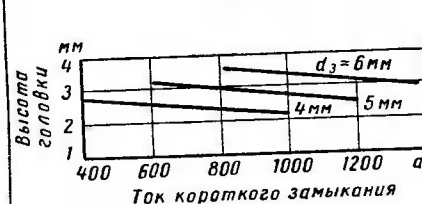
Фиг. 37. Высота головки электрозаклепки в зависимости от тока короткого замыкания и диаметра электрода. U_{xx} = 65 в; флюс АН-348А.
