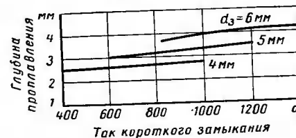
Фиг. 38. Зависимость глубины проплавления от тока короткого замыкания и диаметра электрода. U_{xx} = 65 в; флюс АН-348А.
