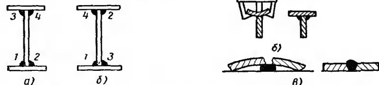
Фиг. 16. Уравнивание деформаций при сварке двутавровых балок: а — неправильная последовательность наложения швов; б — правильная последовательность наложения швов.
