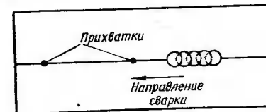
Фиг. 9. Сварка методом последовательного образования сварочных ванночек
