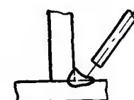
Фиг. 25. Сварка таврового соединения при величине катета шва до 10 мм.
