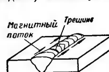
Фиг. 30. Продольное намагничивание шва.
