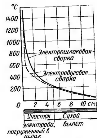
Фиг. 5. Характер нагрева электрода при дуговой и электрошлаковой сварке
