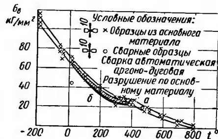
Фиг. 190. Зависимость статической прочности сварного соединения от температуры.
