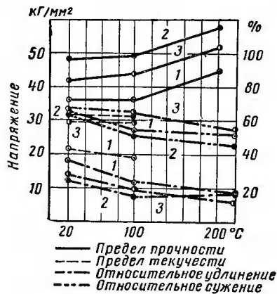
Фиг. 55. Результаты испытания габаритных образцов (ЦНИИТМАШ): 1 — основной металл (МСт.2); 2 — металл шва; флюс АН-1, кремнемарганцовистая проволока; 3 — металл шва, флюс ОСЦ-45, малоуглеродистая проволока.
