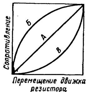
Рис. 4.2. Зависимость сопротивления от величины перемещения движка резистора
