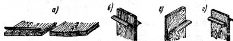
Рис. 128. Оклейка щита фанерой
