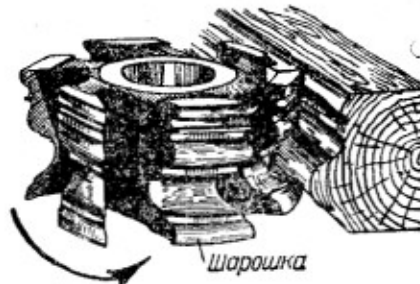
Рис. 71 а. Шарошка (фреза)
