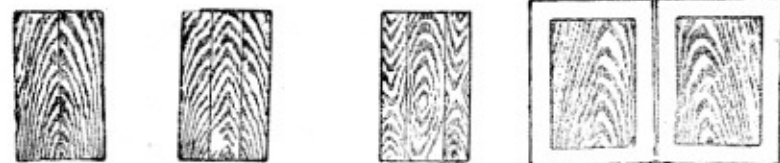
Рис. 131. Подборка фанеры по текстуре при симметричном расположении отдельных листов
