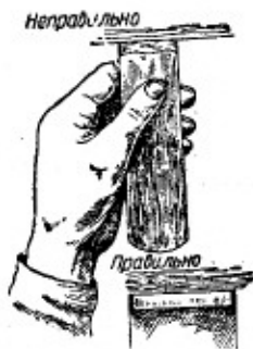
Рис. 44. Проверка заточки рубаночной железки
