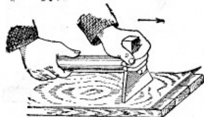
Рис. 136. Фанерование в притирку при помощи притирочного молотка
