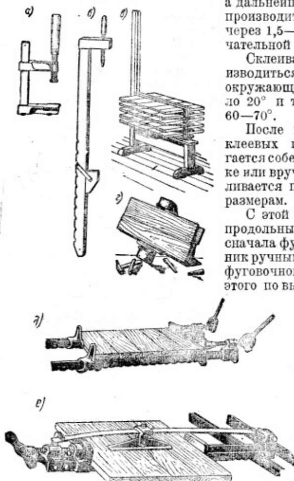
Рис. 124. Зажимные приспособления: а—металлическая струбцина; б—вайма с переставным упором; в—сжим для щитов; 2—деревянная клиновидная вайма; д—металлическая винтовая вайма; е—металлическая вайма с прижимом
