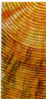
Рис. 4. Заболонные грибные окраски: а — сисева (розовая и коричневая); б — побурение; в — заболонная гниль (сосна)
