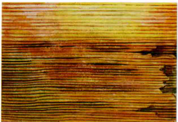
Рис. 4. Заболонные грибные окраски: а — сисева (розовая и коричневая); б — побурение; в — заболонная гниль (сосна)
