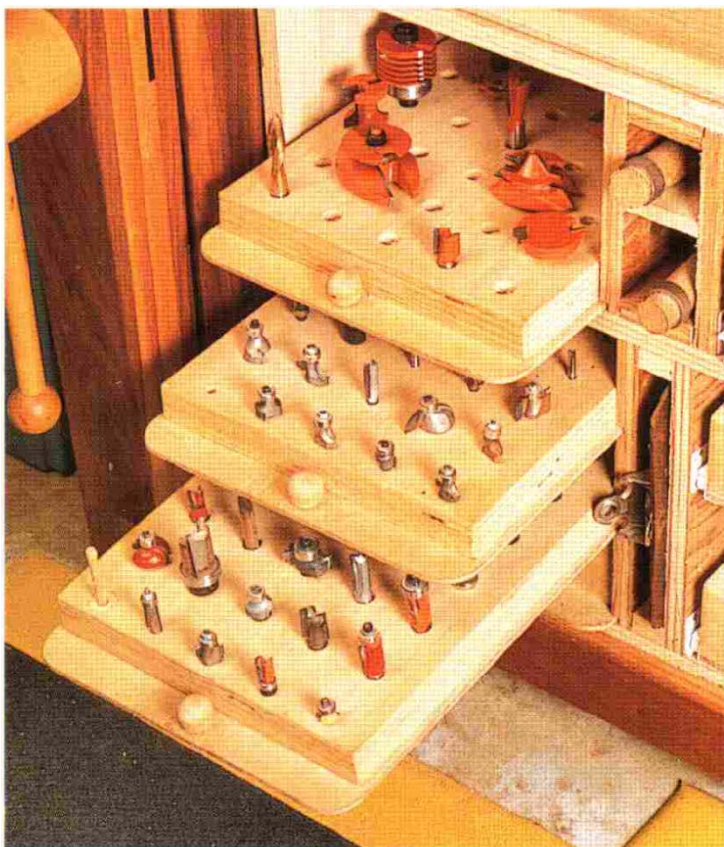
Съемные, выдвижные полки для хранения фрез. Храните фрезы рядом с местом работы, сделав ряд выдвижных полок. Дно из более тонкой фанеры скользит в боковых пазах.
