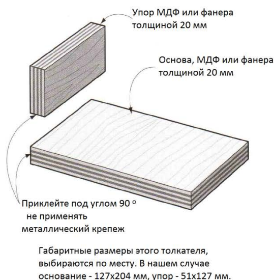
Рис. 9: СКОЛЬЗЯЩИЙ ТОЛКАТЕЛЬ
