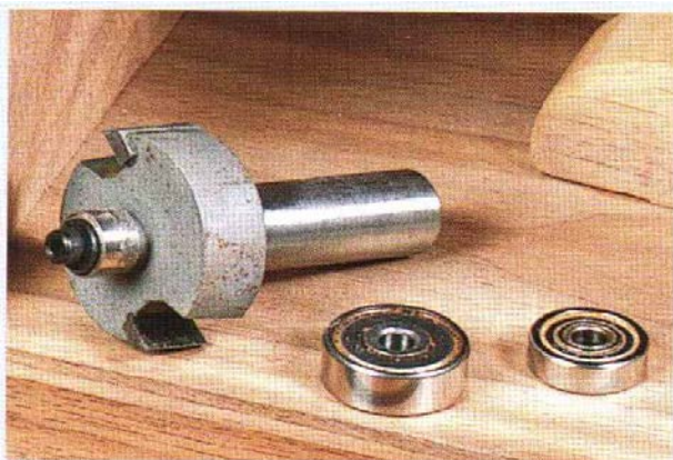
Фальцевая фреза для выборки четвертей, со сменными подшипниками.
