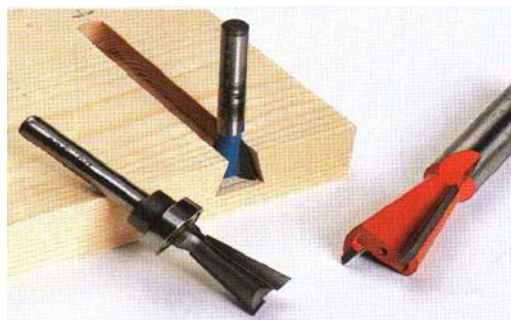
Фрезы «ласточкин хвост». Согласуйте их размер и размер шипорезного приспособления.
