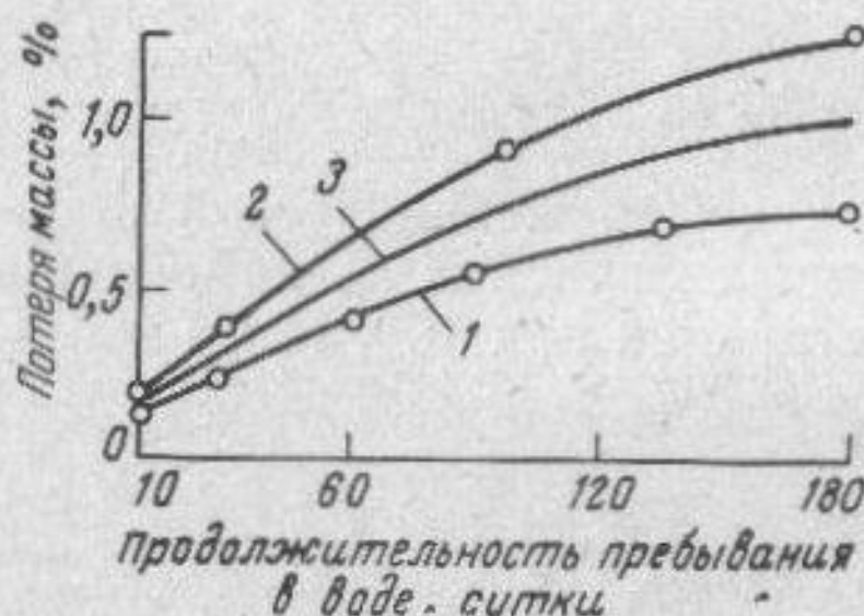
Рис. 15. Потеря массы эпоксидными композициями после действия воды:
