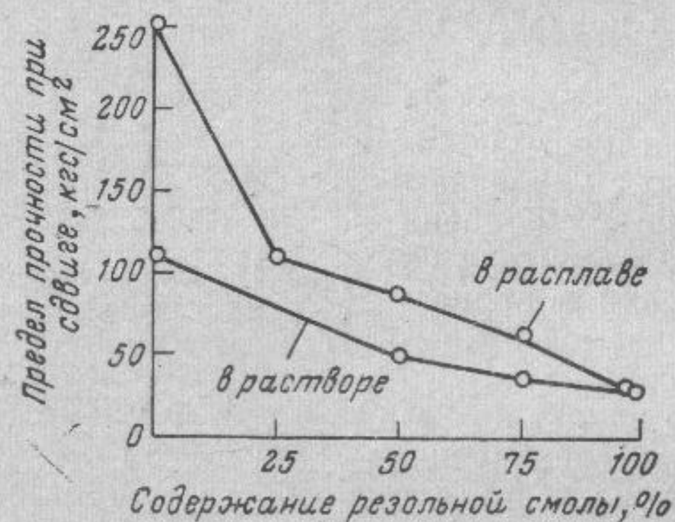
Рис. 19. Влияние растворителя на клеящую способность эпоксидно-фенольной композиции, содержащей различные количества резольной смолы.
