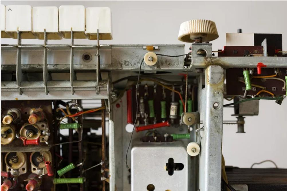
Он отвечает за подстройку колебательного контура при регулировании высоких частот. Оригинальная верёвка в нескольких местах истлела, но я подобрал похожую.
