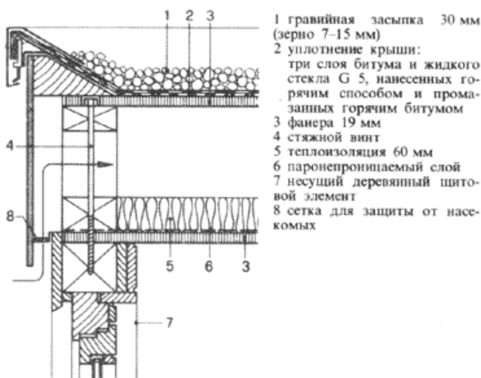
38-39 Кровельные щиты соединены со стенами заподлицо
