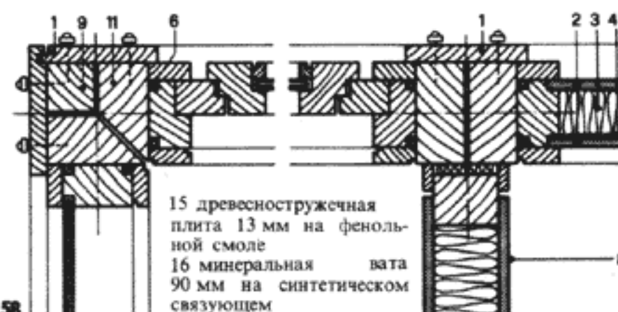
1 закрывающая доска 2 асбестоцементная плита 3 теплоизоляция 4 пароизоляция
