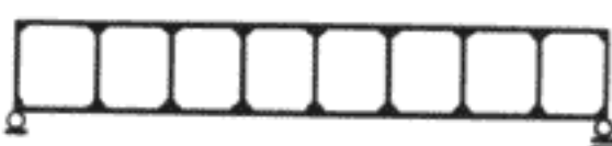
Ферма с жесткими и жестко прикрепленными стойками. Безраскосная ферма (для малых пролетов) как особая форма
