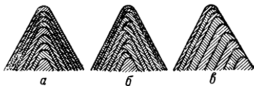
Фиг. 256. Образование винтовой канавки резьбы при различных способах углубления реза.
