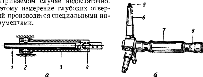
Фиг. 150. Инструменты для измерения глубоких отверстий.
