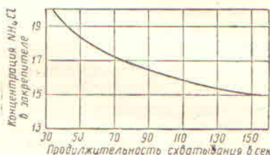
Фиг. 25. График зависимости продолжительности схватывания эталонного стекла от концентрации \text{NH}_4\text{Cl} в закрепителе.
