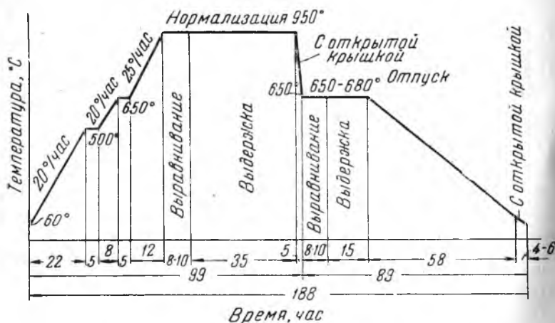
Рис. 180. Режим термообработки вала
