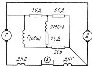
Рис. 139. Мостовая схема включения обмотки гибкой связи по напряжению генератора
