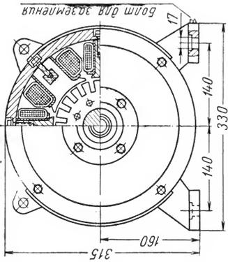
Рис. 102. Электродвигатель ДПЭ-12 механизма открывания днища ковша
