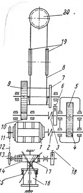
Рис. 29. Кинематическая схема подъемной и стреловой лебедок
