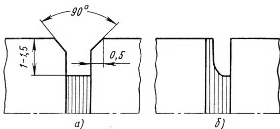
Рис. 172. Прорезание канавок между пластинами коллектора:
