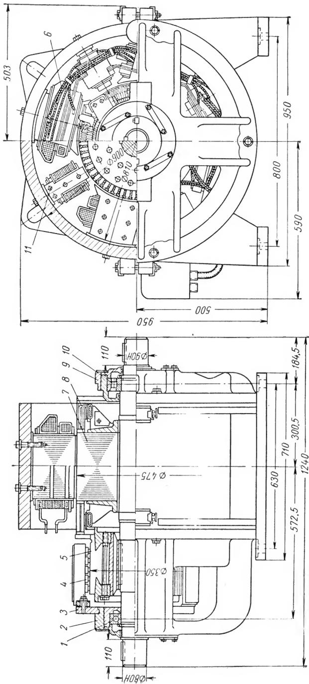
Рис. 114. Генератор ПЭМ-2000
