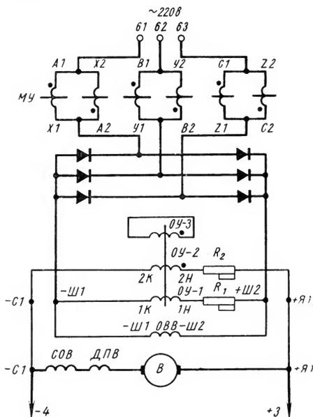
Рис. 165. Принципиальная схема регулирования напряжения возбудителя в зависимости от температуры (блок типа БГА3501-02В2)
