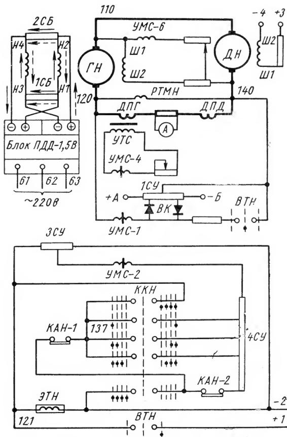
Рис. 148. Схема управления приводом напора
