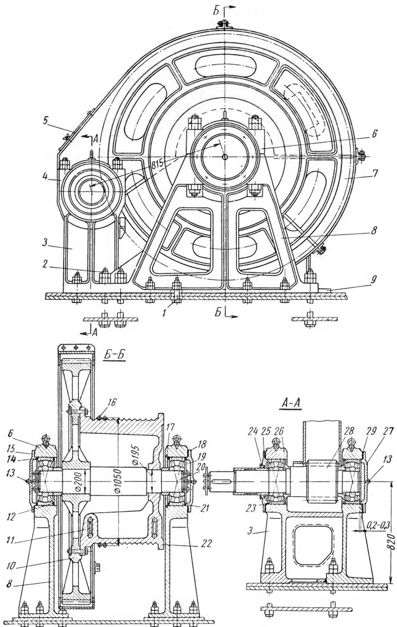
Рис. 35. Привод барабана
