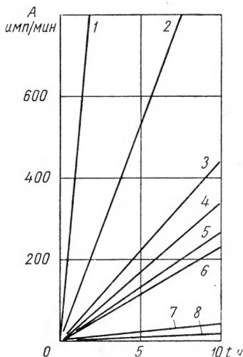
Рис. 76. Кривые износа шестерни редуктора СКР-11 при использовании различных масел:
