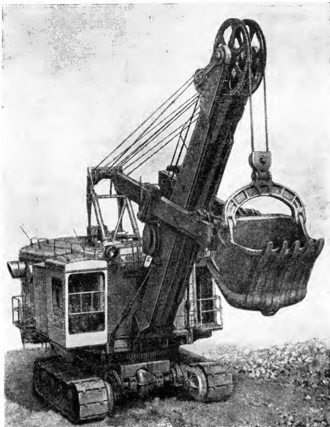
Рис. 7. Рабочее оборудование экскаватора ЭКГ-4,6А
