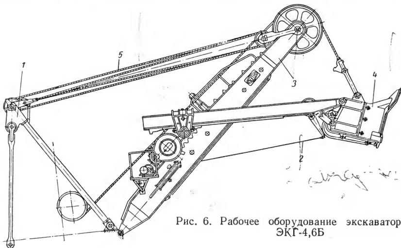
Рис. 6. Рабочее оборудование экскаватора ЭКГ-4,6Б
