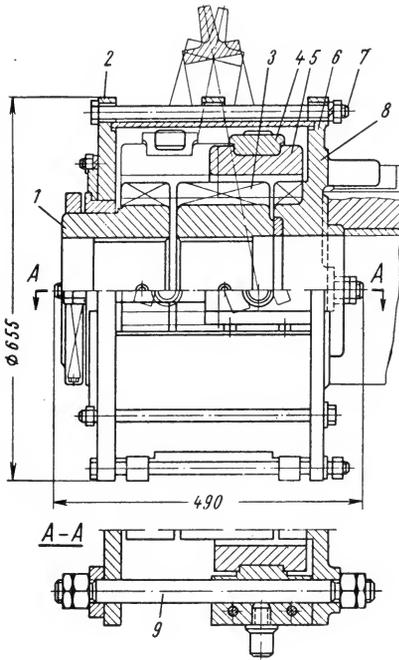
Рис. 59. Муфта переключения гусениц экскаватора ЭКГ-4,6А
