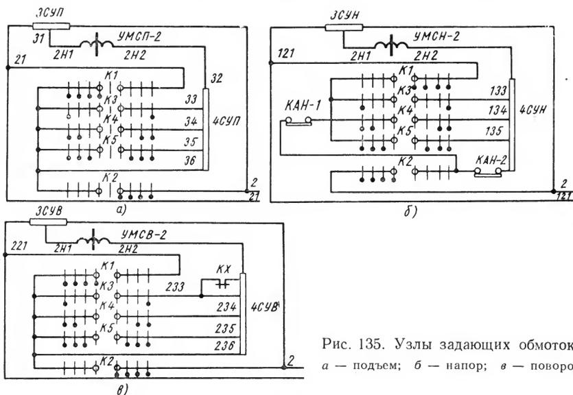
Рис. 135. Узлы задающих обмоток: а — подъем; б — напор; в — поворот
