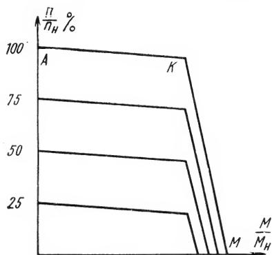
Рис. 151. Разбивка скорости приводов по положениям командоконтроллера
