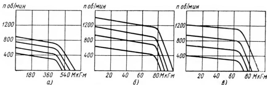
Рис. 95. Механические характеристики экскаватора ЭКГ-5 с магнитным возбуждением:
