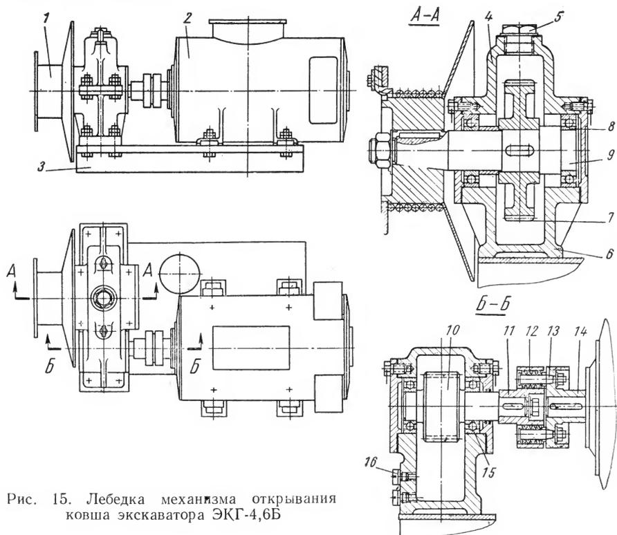
Рис. 15. Лебедка механизма открывания ковша экскаватора ЭКГ-4,6Б
