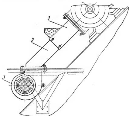
Рис. 22. Установка вентилятора двигателя напорного механизма
