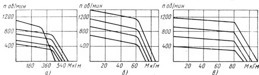
Рис. 94. Механические характеристики экскаваторов ЭКГ-4,6А и ЭКГ-4,6Б с возбуждением от магнитных усилителей:
