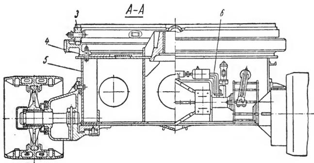
Рис. 4. Ходовая тележка экскаватора ЭКГ-4,6А
