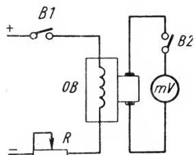
Рис. 146. Схема определения точной установки траверсы
