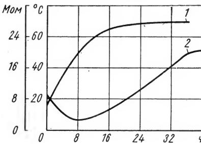
Рис. 144. Кривые сопротивления изоляции (1) и температуры нагрева (2) машины
