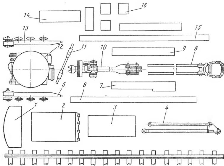
Рис. 90. Схема расположения узлов экскаватора на монтажной площадке
