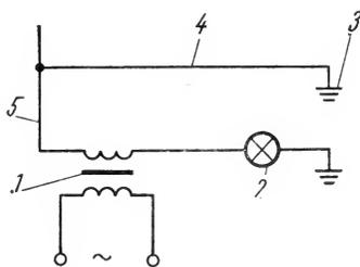
Рис. 145. Схема проверки соединений схем
