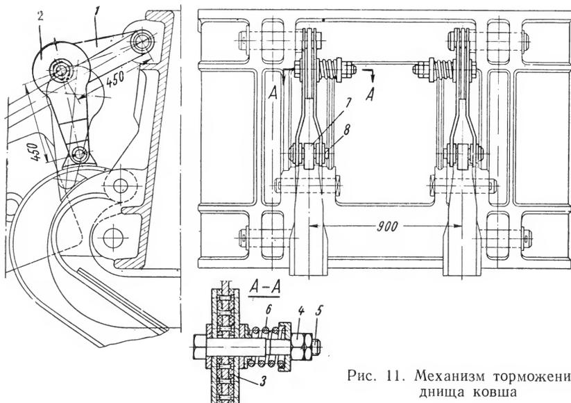
Рис. 11. Механизм торможения днища ковша
