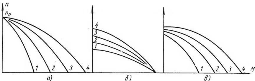
Рис. 131. Внешние характеристики генератора при изменении числа ампер-витков:
