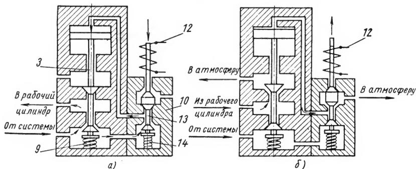
Рис. 47. Принцип действия электропневматического распределителя:
