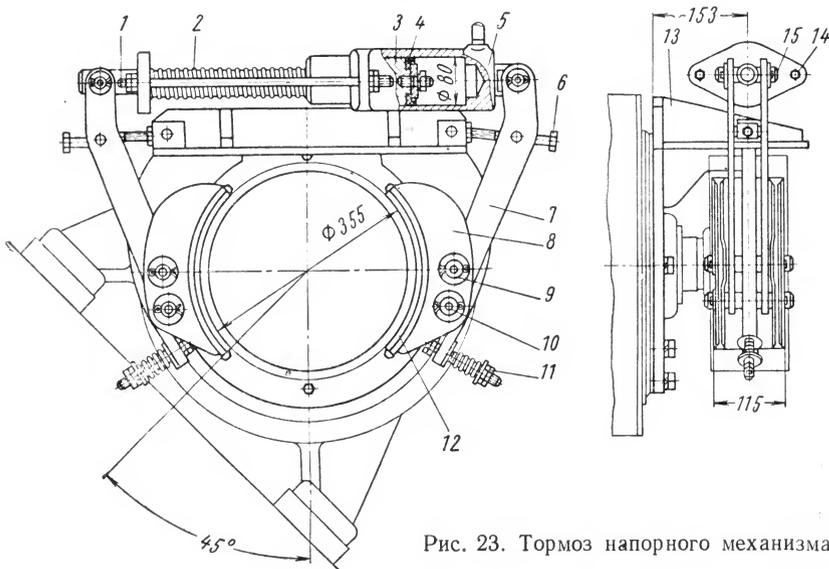
Рис. 23. Тормоз напорного механизма
