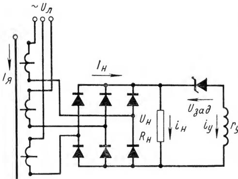
Рис. 169. Схема для построения характеристики холостого хода
