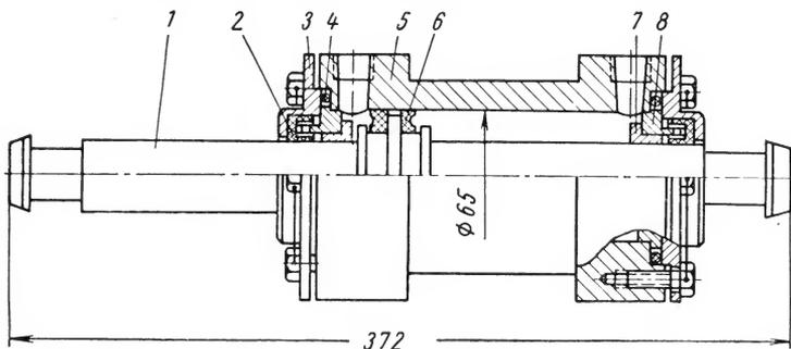
Рис. 73. Гидравлический цилиндр
