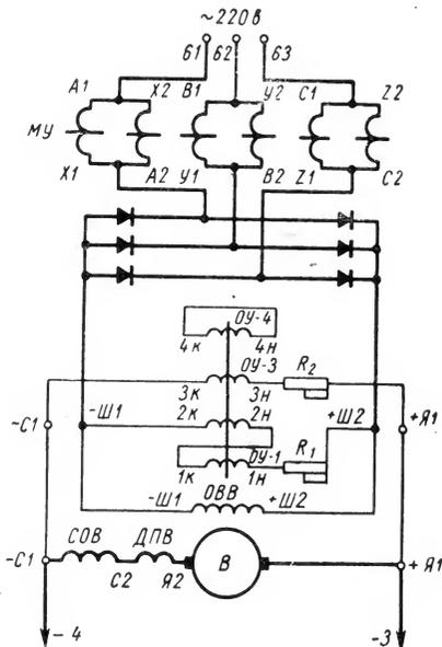
Рис. 167. Принципиальная схема регулирования напряжения возбудителя в зависимости от температуры (блок типа БГА3501-02Б2)
