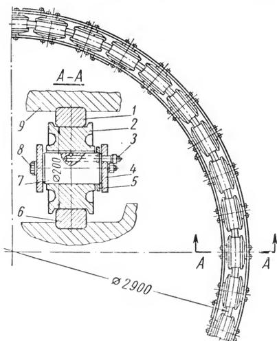
Рис. 62. Роликовый круг
