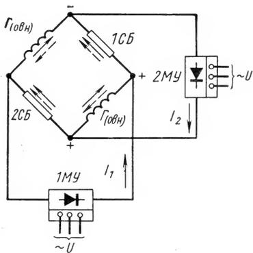
Рис. 134. Схема возбуждения генератора от магнитного усилителя
