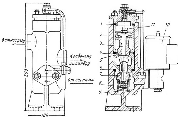
Рис. 46. Электропневматический распределитель
