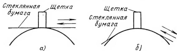
Рис. 174. Схема шлифовки щеток к коллектору:
