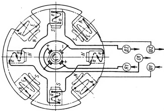
Рис. 104. Схема соединений электродвигателя типа ДПВ-52
