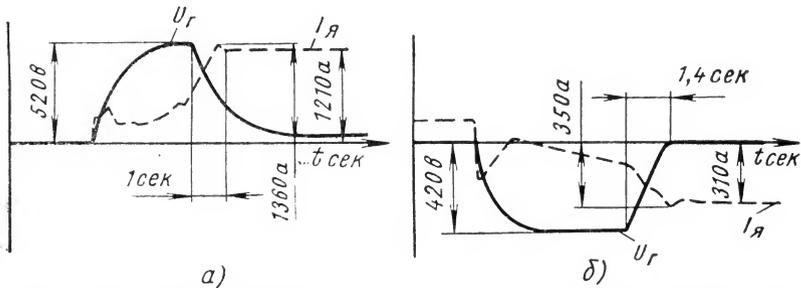
Рис. 157. Осциллограммы стопорения рабочих механизмов подъема (а) и напора (б)
