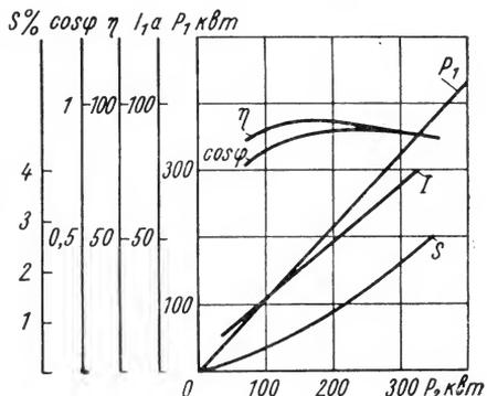
Рис. 117. Рабочие характеристики электродвигателя АЭ-113-4
