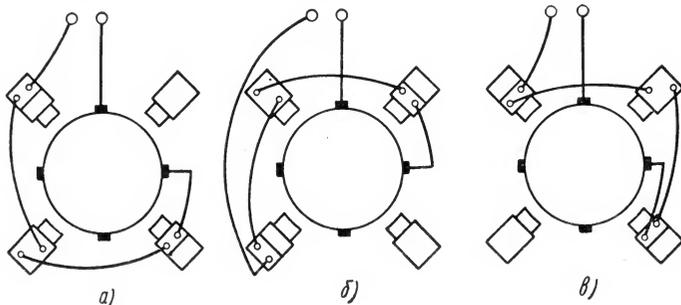
Рис. 182. Принципиальные схемы соединения обмоток добавочных полюсов
