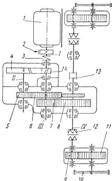
Рис. 68. Кинематическая схема привода хода экскаватора ЭКГ-4,6Б
