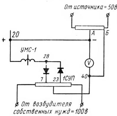
Рис. 153. Согласование полярности узла токовой отсечки
