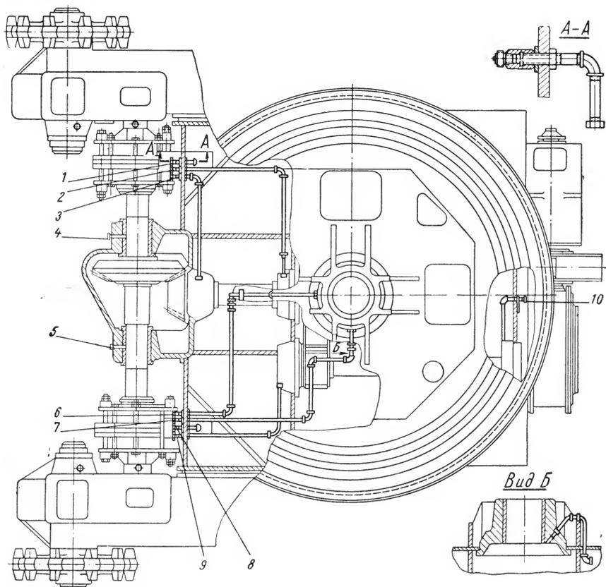
Рис. 53. Система густой смазки ходового механизма экскаватора ЭКГ-4,6А
