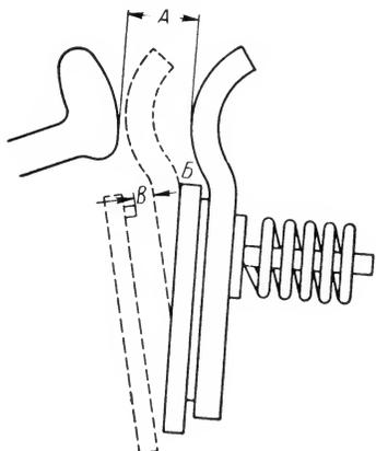
Рис. 171. Определение раствора и провала контактов контактора
