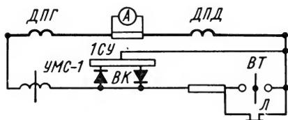
Рис. 136. Узел токовой отсечки
