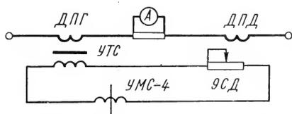
Рис. 140. Узел гибкой связи по току главной цепи
