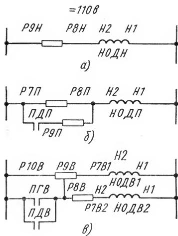
Рис. 158. Схемы подключения обмоток возбуждения:
