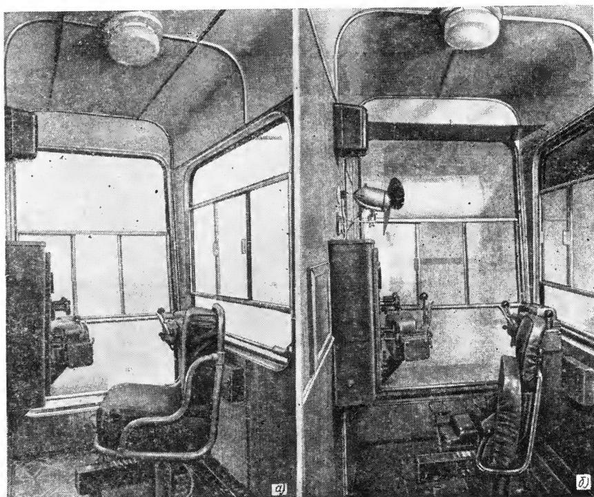
Рис. 48. Внутренний вид кабины машиниста экскаваторов ЭКГ-4,6А (а) и ЭКГ-4,6Б (б)
