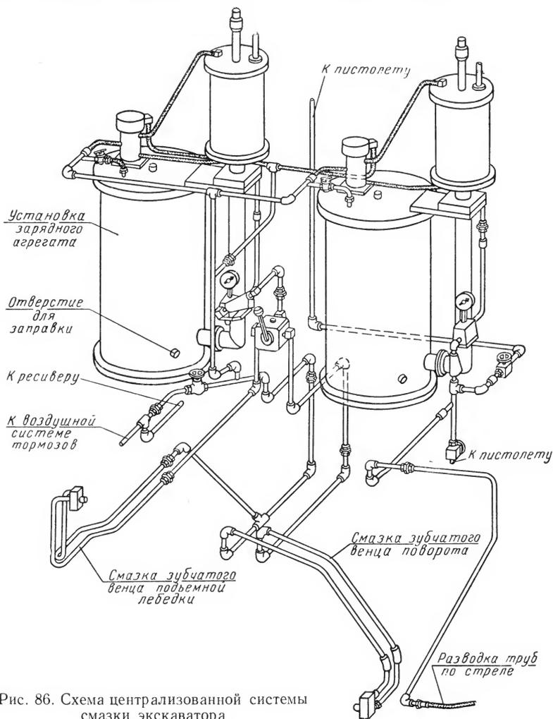
Рис. 86. Схема централизованной системы смазки экскаватора
