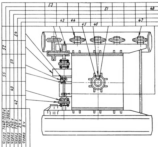
Рис. 89. Карта № 3. Смазка механизмов ходовой тележки
