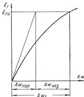
Рис. 142. График для определения соотношения ампер-витков обмоток возбуждения
