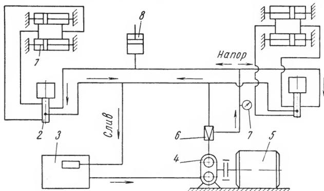
Рис. 74. Принципиальная схема гидравлической системы экскаватора ЭКГ-4,6Б
