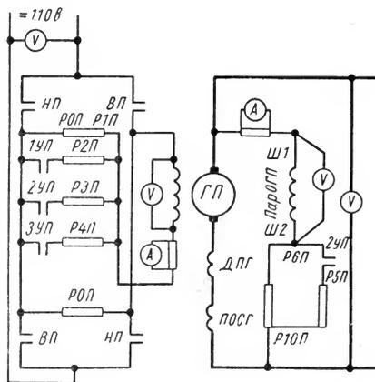
Рис. 159. Схема регулирования напряжения холостого хода генераторов
