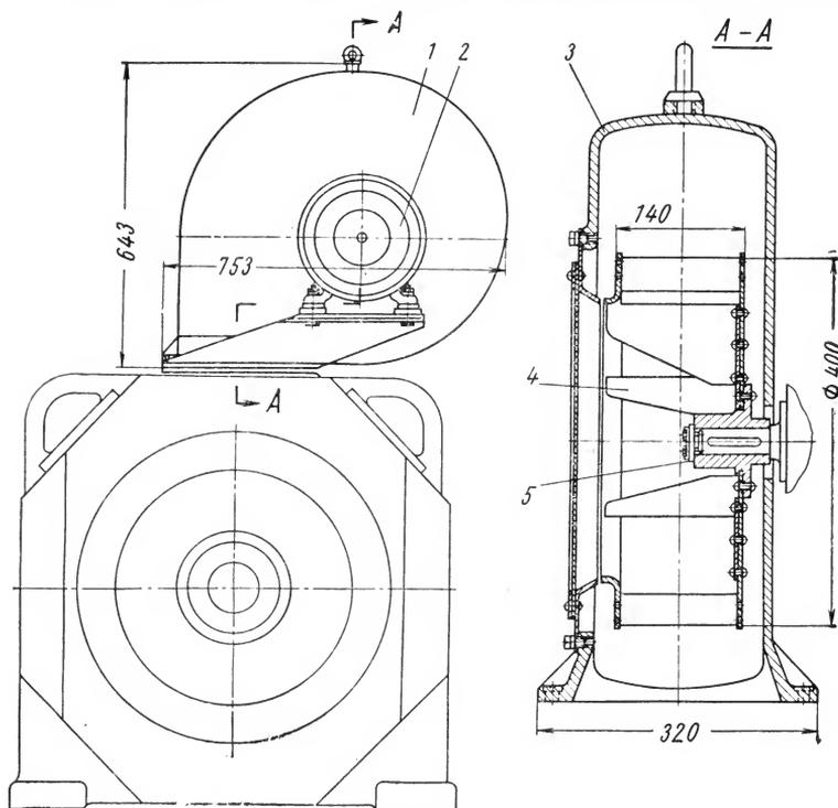
Рис. 31. Установка вентилятора на двигателе подъемной лебедки
