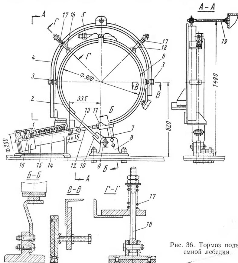
Рис. 36. Тормоз подъемной лебедки.
