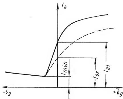
Рис. 124. Характеристики блоков ПДД-1,5В (сплошная линия) и ПДД-1,5ВА (пунктирная)
