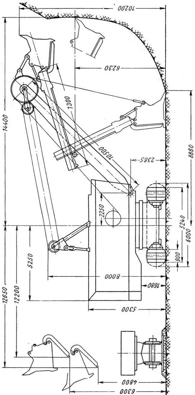
Рис. 3. Рабочие и габаритные размеры экскаватора ЭКГ-4,6А
