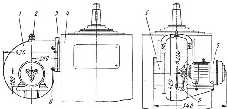
Рис. 39. Установка вентилятора на двигателе поворотного механизма
