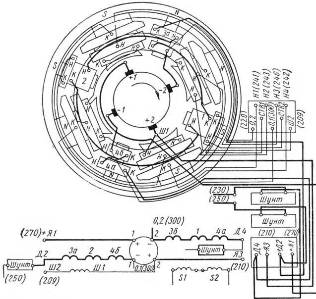
Рис. 110. Схема внешних и внутренних соединений генератора ПЭМ-1000, 80 квт, 383 в
