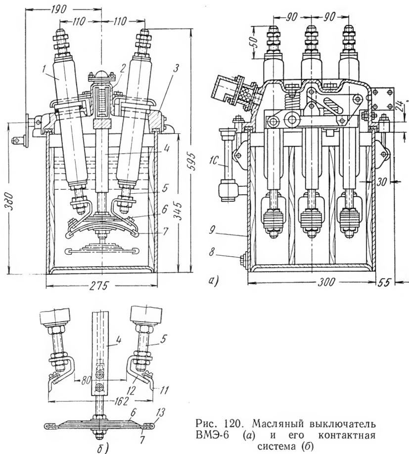
Рис. 120. Масляный выключатель ВМЭ-6 (а) и его контактная система (б)
