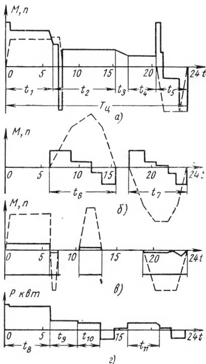
Рис. 97. Расчетные нагрузочные диаграммы приводов экскаваторов ЭКГ-4,6А и ЭКГ-4,6Б
