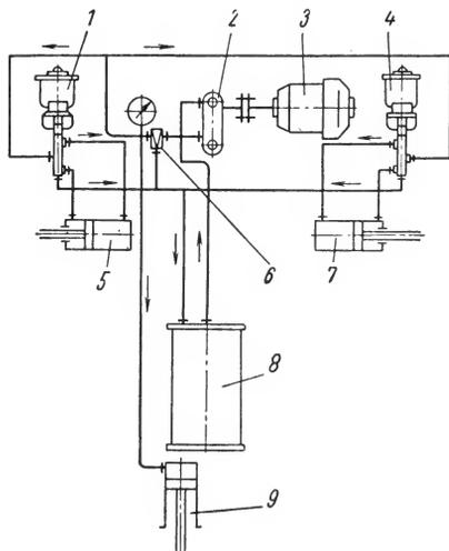
Рис. 63. Принципиальная схема гидравлической системы экскаватора ЭКГ-4,6А
