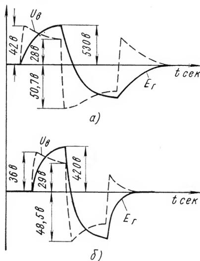
Рис. 152. Осциллограммы холостого хода с подключенной обмоткой совмещенной гибкой и жесткой связи по напряжению генератора:
