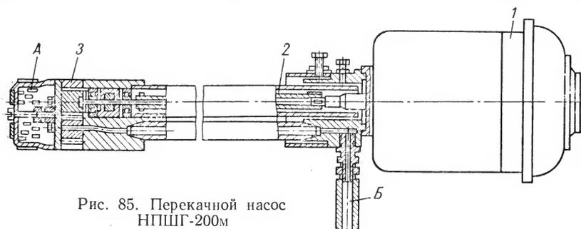
Рис. 85. Перекачной насос НПСШГ-200м
