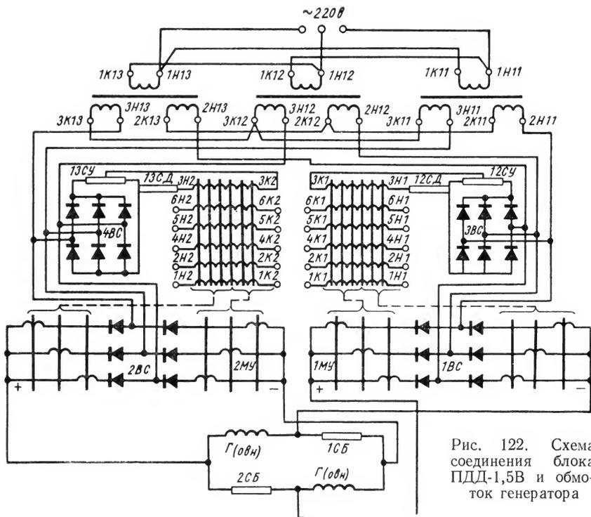
Рис. 122. Схема соединения блока ПДД-1,5В и обмоток генератора
