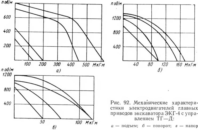
Рис. 92. Механические характеристики электродвигателей главных приводов экскаватора ЭКГ-4 с управлением ТГ—Д:
