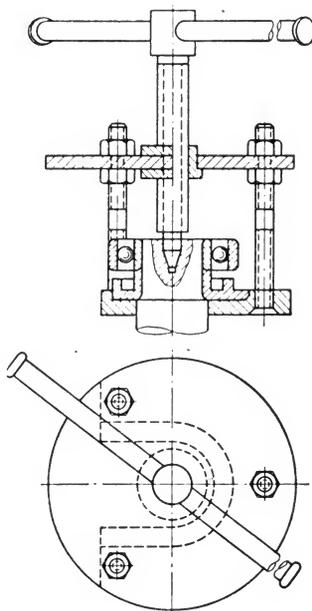
Рис. 175. Струбцина для стягивания шарикоподшипников
