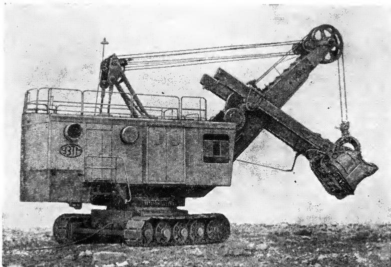
Рис. 1. Экскаватор ЭКГ-4,6А
