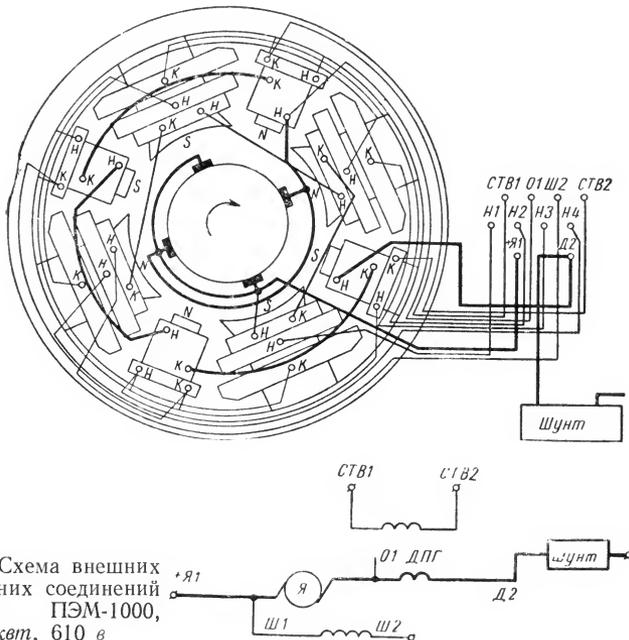
Рис. 111. Схема внешних и внутренних соединений генератора ПЭМ-1000, 100 квт, 610 в
