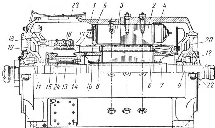
Рис. 99. Электродвигатель ДПЭ-82 механизма подъема:
