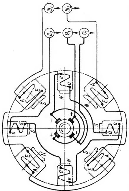
Рис. 105. Схема соединений электродвигателя типа ДПЭ-52
