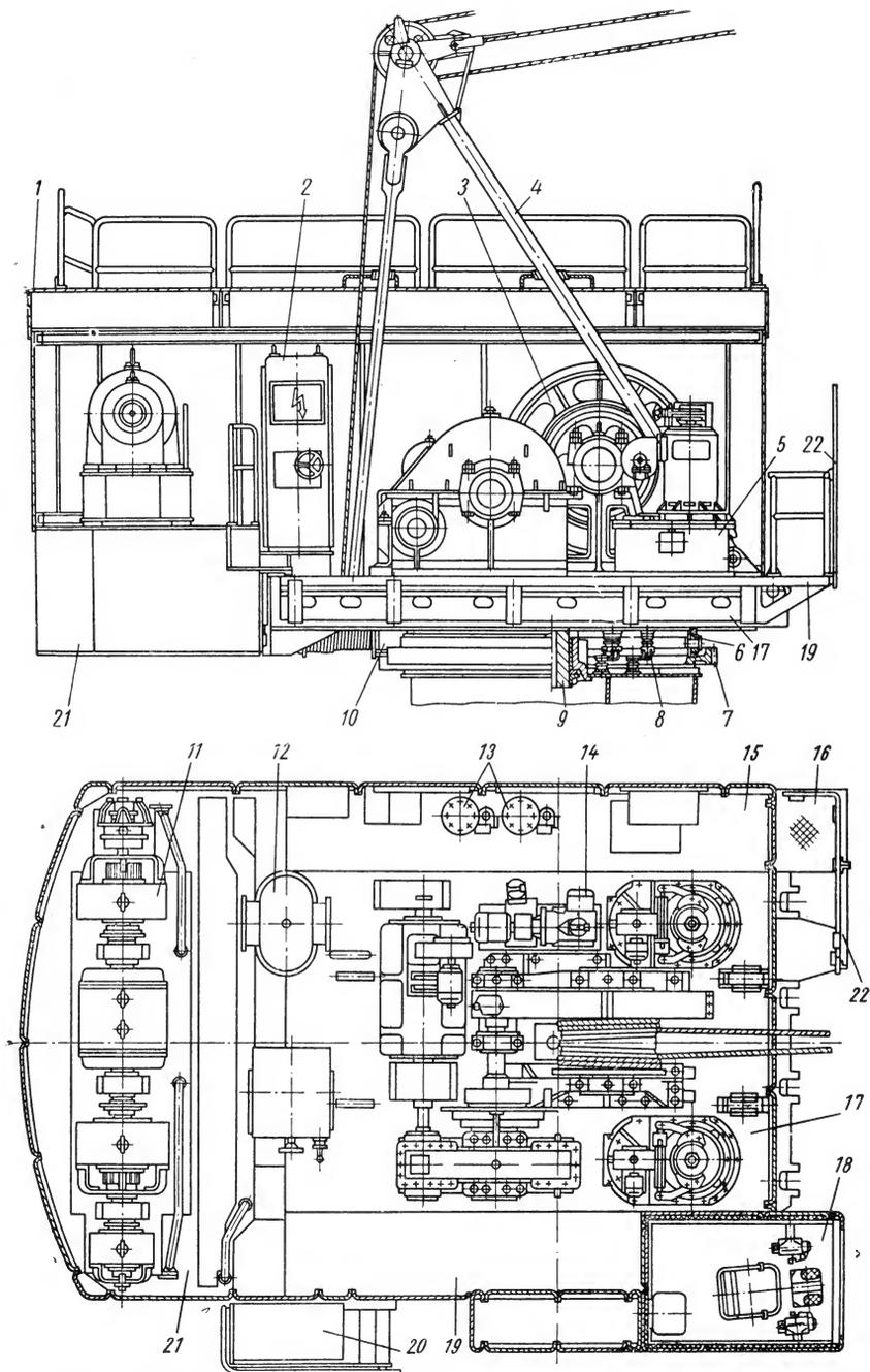
Рис. 5. Поворотная платформа экскаватора ЭКГ-4,6А с механизмами
