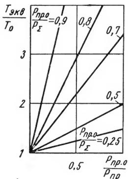
Рис. 141. Зависимость  $\frac{T_{экв}}{T_0}$  от  $\frac{P_{пр.о}}{P_{пр}}$  при разном соотношении ампер-витков независимой и параллельной обмоток
