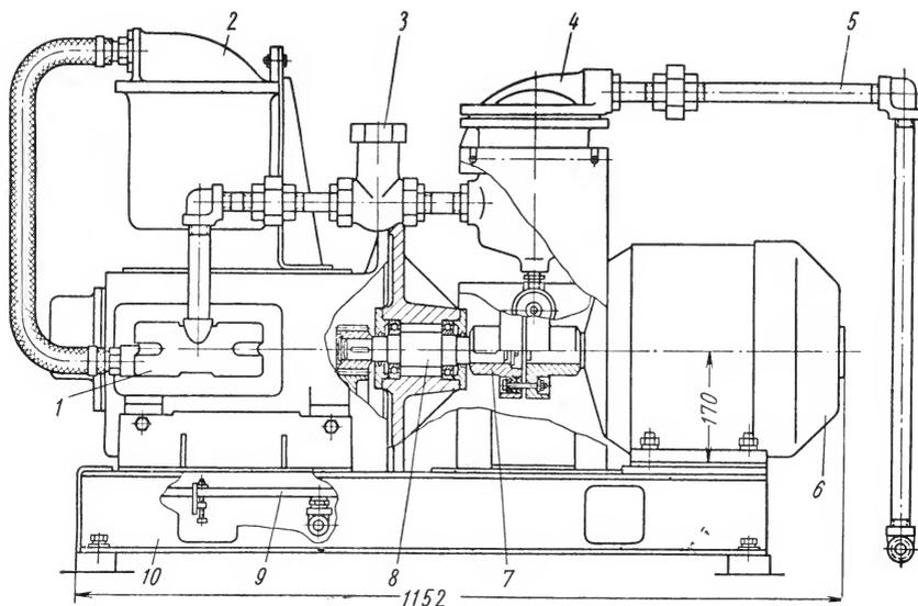
Рис. 44. Установка компрессора
