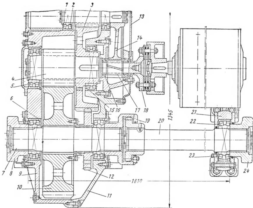
Рис. 70. Редуктор хода экскаватора ЭКГ-4,6Б
