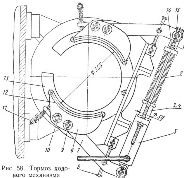
Рис. 58. Тормоз ходового механизма
