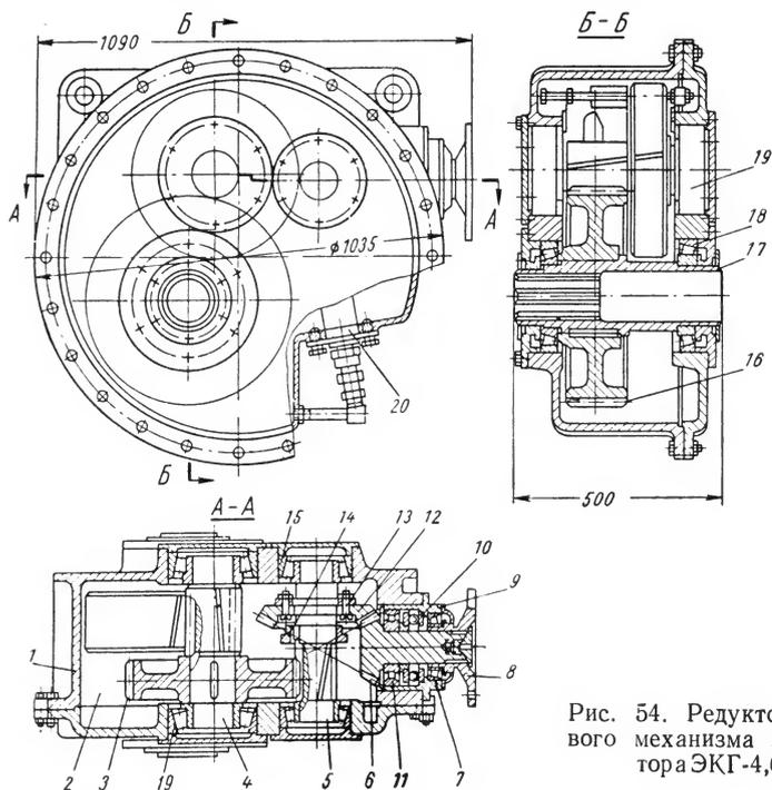
Рис. 54. Редуктор ходового механизма экскаватора ЭКГ-4,6А
