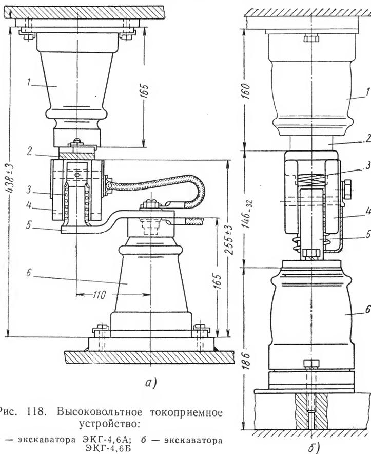
Рис. 118. Высоковольтное токоприемное устройство:
