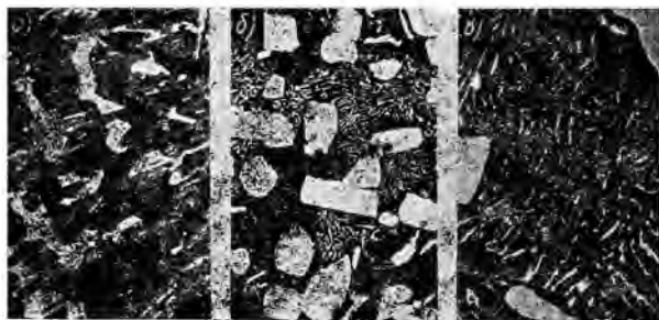
Рис. 1.73. Микроструктуры марганцовых белых чугунов, залитых в кокиль (2,5% С; 31,2% Мп): а — в сыром состоянии ( \times 900 ); б — после термической обработки ( \times 900 ); в — с участками перлитоподобной составляющей ( \times 1450 )
