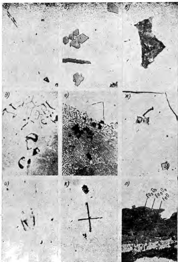
Рис. 1.27. Неметаллические включения в чугунах: а — сульфиды и оксиды ( \times 1000 ); б — эндогенное сложное оксидное включение ( \times 500 ); в — тот же образец, что и в, но в полярном свете; д — оксидные и сульфидные включения, содержащие магний сульфиды, содержащие РЗМ ( \times 500 ); ж, з — карбонитриды титана ( \times 500 ); и — оксидная пленка на ВЧШГ, образовавшаяся после 100 ч ( \times 500 ); к — оксидная пленка на \text{SiC} , образовавшаяся при 700^\circ\text{C} , ( \times 500 ); л — оксидная пленка на ВЧШГ, образовавшаяся после 100 ч ( \times 500 ), с пометками: \text{Fe}_2\text{O}_3 , \text{Fe}_3\text{O}_4 , \text{FeO} .
