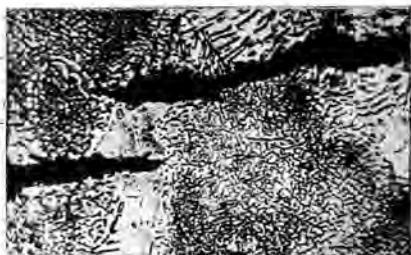
Рис. 1.56. Микроструктура алюминиевого чугуна (3,5% C; 3,0% Al; 1,5% Si) в сыром состоянии ( \times 450 ).
