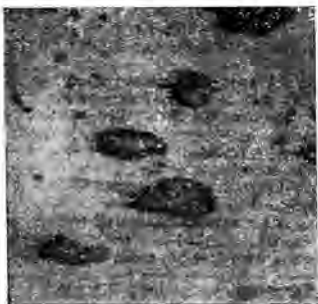
Рис. VIII.10. Структура высокопрочного чугуна после деформации на 20% ( \times 130 )
