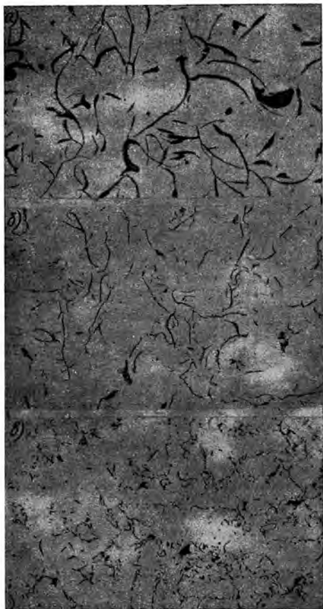
Рис. VII.2. Влияние холодильников на графит в отливке с приведенной толщиной 30 мм на расстоянии 15 мм от поверхности: а — без холодильников; б — с шиповидными холодильниками; в — с плоскими холодильниками
