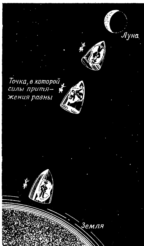
Р и с. 3а. Неправильное предсказание. Жюль Верн полагал, что пассажир свободно летящего снаряда будет стоять на том дне снаряда, которое ближе к Земле или к Луне, в зависимости от того, притяжение которой из них сильнее, но что собака будет парить рядом со снарядом в течение всего путешествия.
