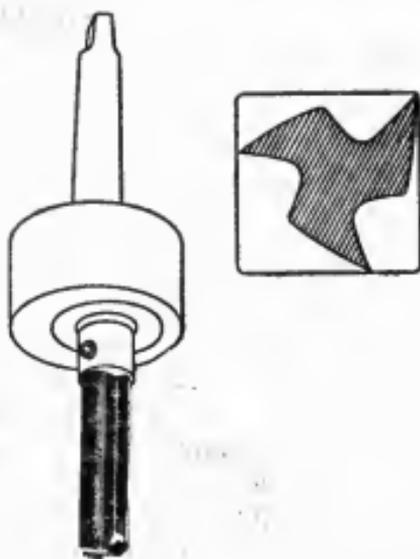
представляет собой просто-напросто треугольник Рело, в котором прорезаны углубления для отвода стружки и заточены режущие кромки. Когда треугольник Рело вращается, его центр не стоит на месте, поэтому патрон для зажима сверла Уаттса не должен препятствовать этому движению. Компания запатентовала специальный патрон со «свободно плавающим в нем сверлом», удовлетворяющий всем нужным требованиям.
