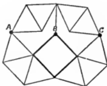
Рис. 186. Плоский каркас из 23 стержней для придания жесткости каркасу.
