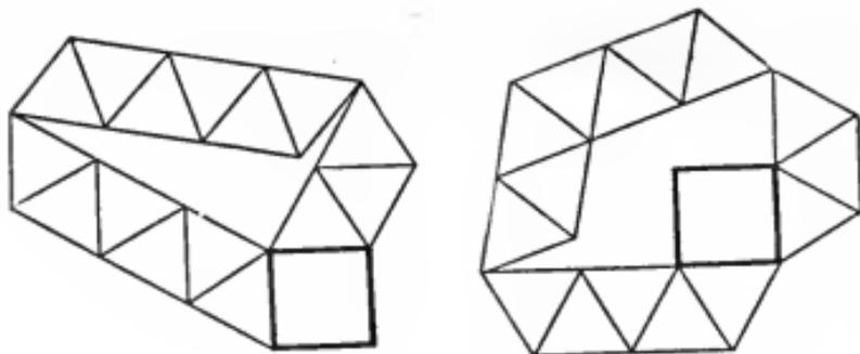
Рис. 184. Плоские каркасы из 31 стержня для придания жесткости квадрату.
