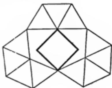
Рис. 185. Плоский каркас из 25 стержней для придания жесткости квадрату.
