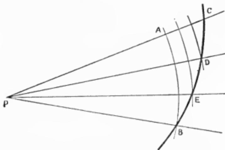
Рис. 87. Трисекция угла с помощью спирали Архимеда.
