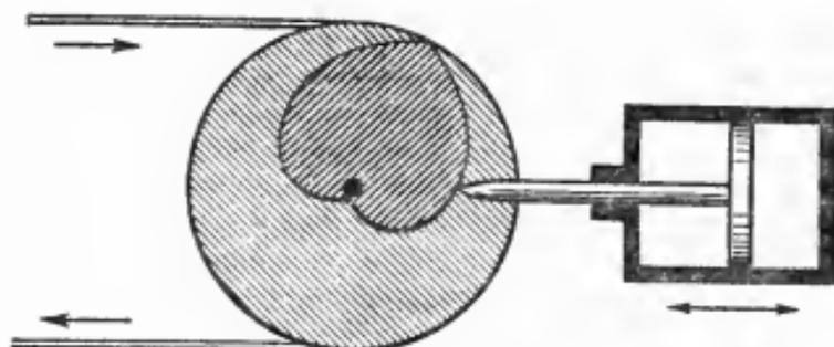
Рис. 88. Преобразование вращательного движения в поступательное с помощью спирали Архимеда.
