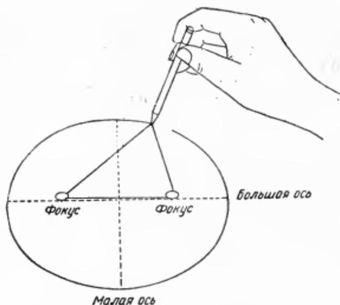
Рис. 7. Простейший способ вычерчивания эллипса.
