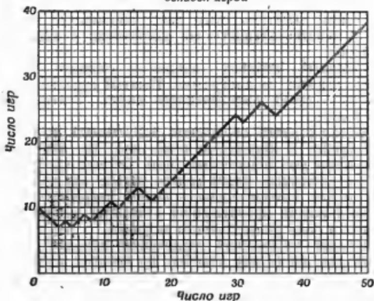
Рис. 82. График обучения машины САМА в первых пятидесяти играх (участок ломаной с наклоном вниз означает поражение, участок с наклоном вверх — победу).
