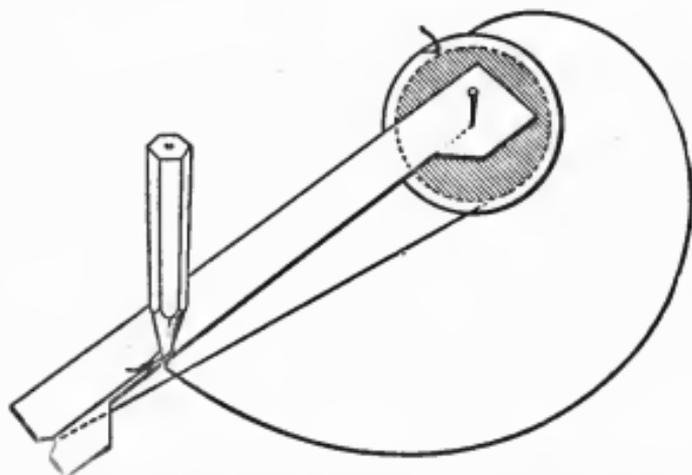
Рис. 86. Устройство для вычерчивания спирали Архимеда.
