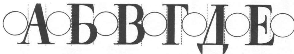
Определение пробелов между буквами при помощи кругов. По П. М. Кузаныну
