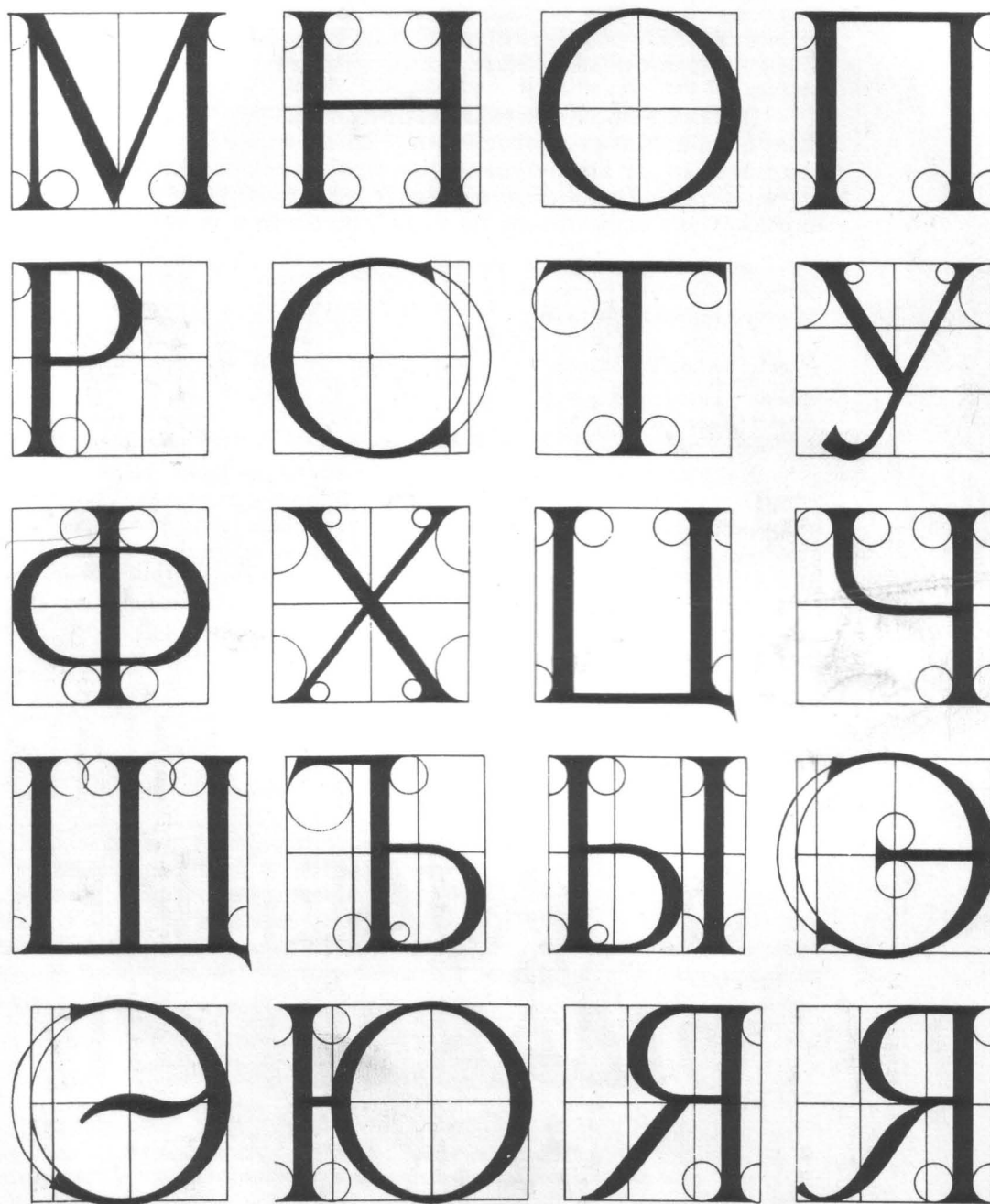
Пример построения прописных букв антиквы. Отношение толщины основных штрихов к высоте буквы — 1 : 10. Отношение ширины соединительных штрихов к ширине основных 1 : 2
