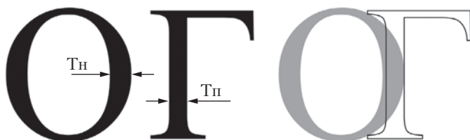
Рис. 1.4. Увеличение толщины наплывов в округлых буквах (Тн) с целью их визуального равенства с толщиной прямых вертикальных штрихов (Тп)
