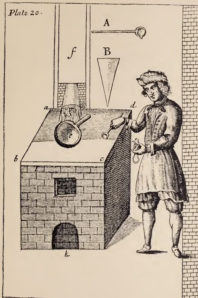
A. Slef. — B. Gjutskyddare af läder. — a, b, c, d. Smältugn. — e. Panna. — f. Skorsten. — g. Eld. — i. Lufthål. — k. Askhål.
