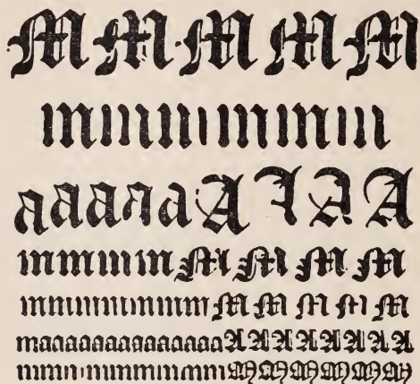
Nr. 18. — Prof på olikheter i typers utseende förorsakade genom dålig gjutning. (Efter Reed.)
