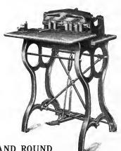
MONITOR DUPLEX POWER PUNCHING AND ROUND CORNER CUTTING MACHINE
